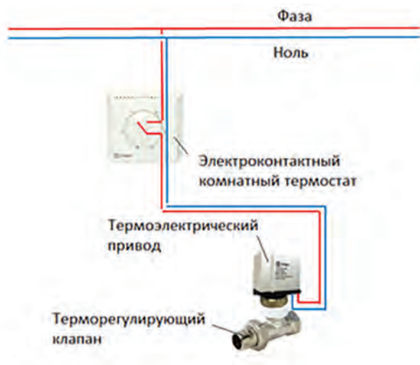
Рис. 3. Схема электрических соединений сети управления
