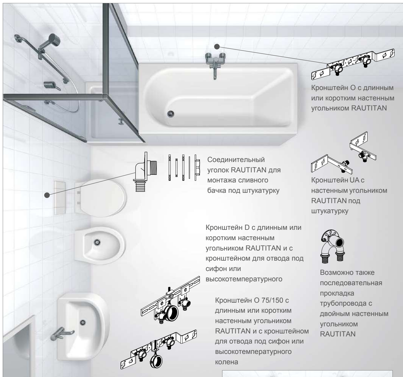
Рис. 6-6. Пример применения кронштейнов в ванной комнате и санузле
