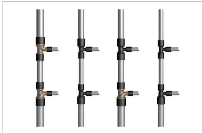
Рис. 5-6. Варианты подключения кольцевого трубопровода
