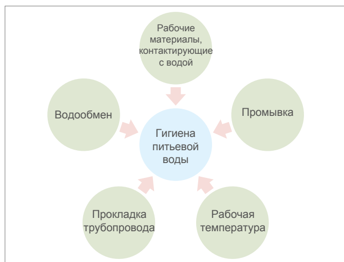
Рис. 5-1 Важные факторы, влияющие на гигиеническое состояние питьевой воды
