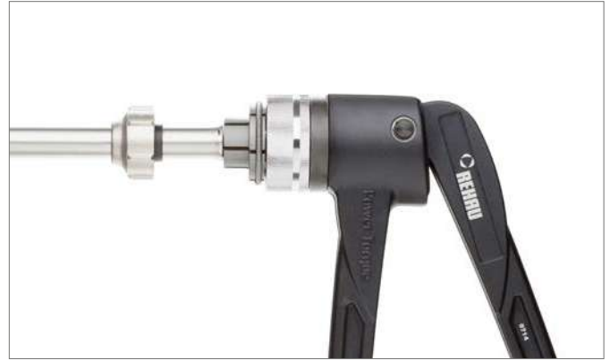
Рис. 14.4. Однократное расширение конца трубы
