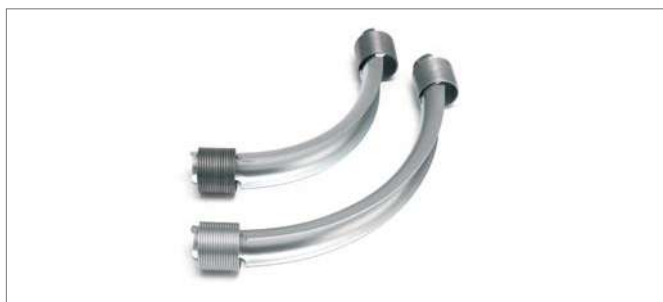
Рис. 32-5 Фиксаторы поворота Водоснабжение (4 x d) - 90° и Фиксаторы поворота Водоснабжение/отопление (5 x d) - 90° соответственно для изгиба труб диаметром 32
