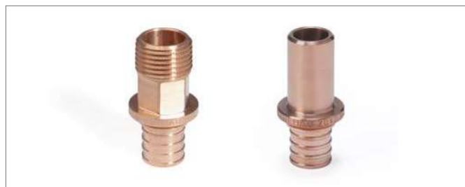
Рис. 26-10 Переходник с наружной резьбой и переходник под пайку и запрессовку (бронза, не содержащая свинца)
