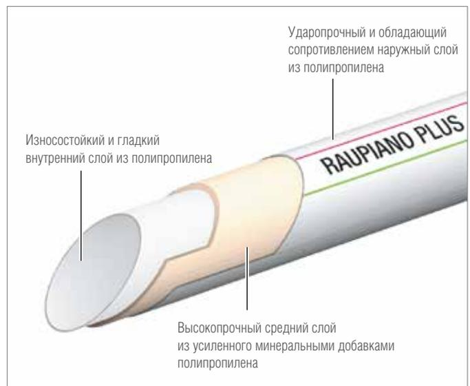
Рис. 12-3 Конструкция трубы RAUPIANO PLUS
