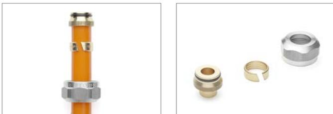
Abb. 2-15 Klemmringverschraubung für das REHAU Rohr RAUTHERM SPEED 16 x 1,5 K
