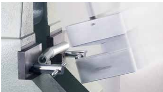
Рис. 3-2 Универсальная труба RAUTITAN flex в установке по испытанию ударной вязкости
