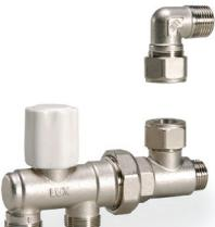
Valvola monotubo diritta a semplice regolazione, verticale con convogliatore di flusso. Portata massima al corpo scaldante: 50% e 100% della portata dell'anello.
