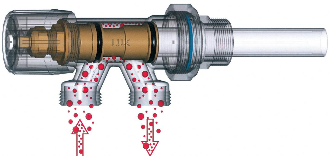
La valvola M 88 in posizione di chiusura ha il bypass al 100% della portata dell'anello, non entra liquido nel corpo scaldante.
