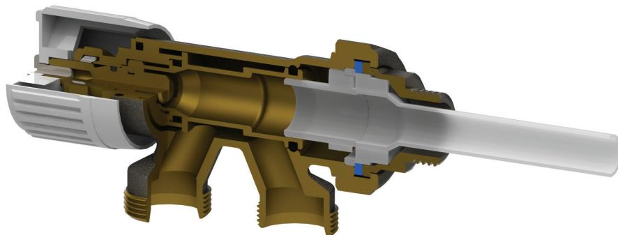
Luxor produce valvole manuali a 4 vie per impianti monotubo e bitubo in grado di soddisfare tutte le esigenze impiantistiche. Tutte le valvole a 4 vie adottano una soluzione costruttiva che permette di avere l'ingresso e l'uscita del flusso da un unico attacco al corpo scaldante. Queste valvole devono essere installate sull'attacco inferiore del corpo scaldante.
