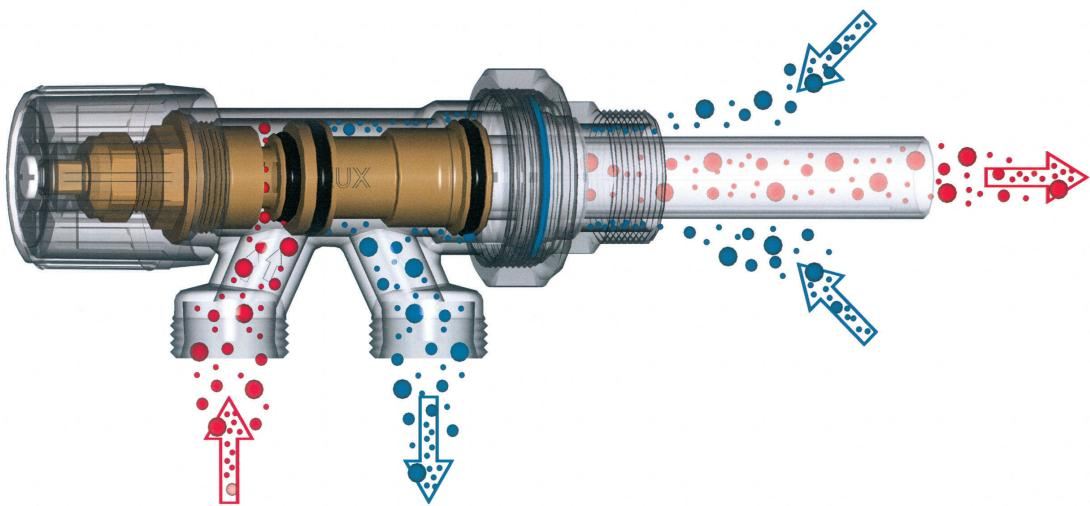
La valvola M 88 in posizione di massima apertura non ha il bypass e il 100% della portata dell'anello entra nel corpo scaldante (vedi immagine).
