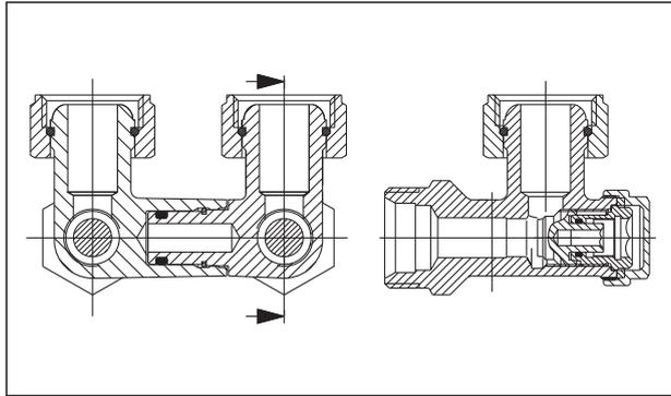
ZB-запорно-присоединительный узел, угловой с функцией слива, заполнения и преднастройки
