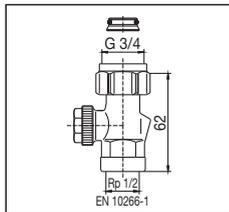
Запорно-присоединительное резьбовое соединение с функциями слива, заполнения и преднастройки G 3/4 НГ x Rp 1/2 BP
