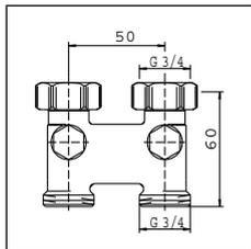
с функцией отключения, межосевое расстояние 50 мм
