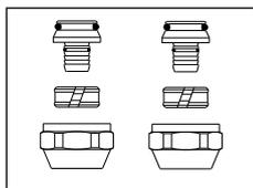
**„Cofit S“ для G ¾ HP по DIN EN 16313 (евроконус) универсальное применение для металлопластиковой трубы „Coripe“ и при аналогичной обработке для полиэтиленовой трубы (PE-X) 2 шт., металлическое уплотнение + уплотнительное кольцо, штуцер из бронзы, стяжное кольцо и накидная гайка из латуни, накидная гайка никелированная**
