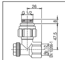
Запорно-присоединительное угловое резьбовое соединение с функциями слива, заполнения и преднастройки G 1/2 HP x Rp 1/2 BP
