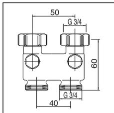
с функцией отключения, межосевое расстояние сверху 50 мм, снизу 40 мм
