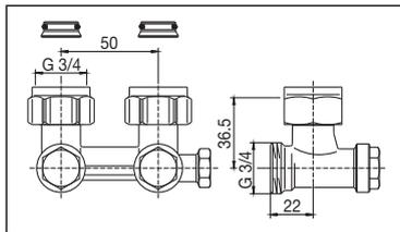
ZBU запорно-присоединительный угловой узел с функциями слива, заполнения и преднастройки G 3/4 НГ x G 3/4 HP
