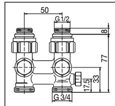
ZBU/CEW запорно-присоединительный узел с функциями слива, заполнения и преднастройки G 1/2 HP x G 3/4 HP
