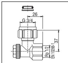
Запорно-присоединительное угловое резьбовое соединение с функциями слива, заполнения и преднастройки G 3/4 НГ x Rp 1/2 BP
