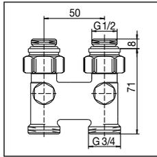
с функцией отключения, межосевое расстояние 50 мм
