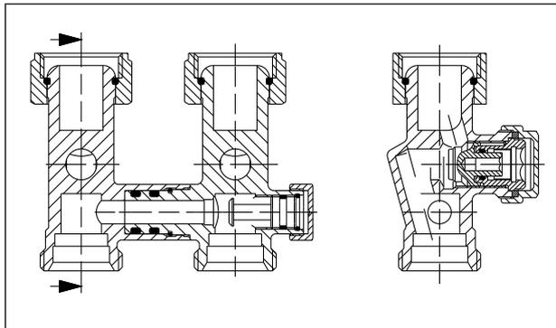
CE-запорно-присоединительный узел с функцией слива, заполнения и преднастройки
