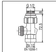
Запорно-присоединительное резьбовое соединение с функциями слива, заполнения и преднастройки G 1/2 HP x Rp 1/2 BP
