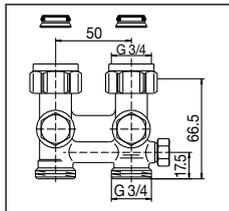
ZBU запорно-присоединительный узел с функциями слива, заполнения и преднастройки G 3/4 НГ x G 3/4 HP
