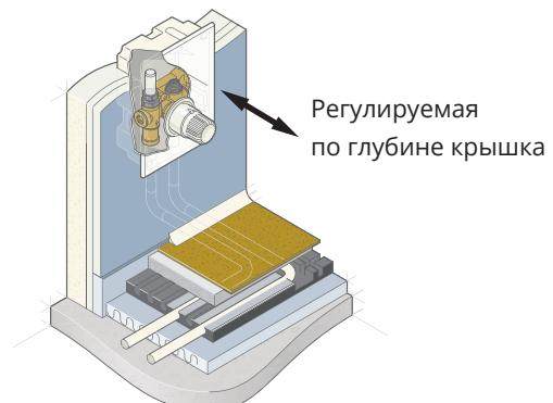
Благодаря удобному монтажному коробу все регулировочные короба Simplex легко подсоединяются к системе напольного отопления.
