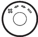
Защитный колпачок служит для защиты на время транспортировки и промывки во время пуска. Сняв защитный колпачок и накрутив головку термостата, получают термостатический клапан, не производя при этом слив воды из системы.
