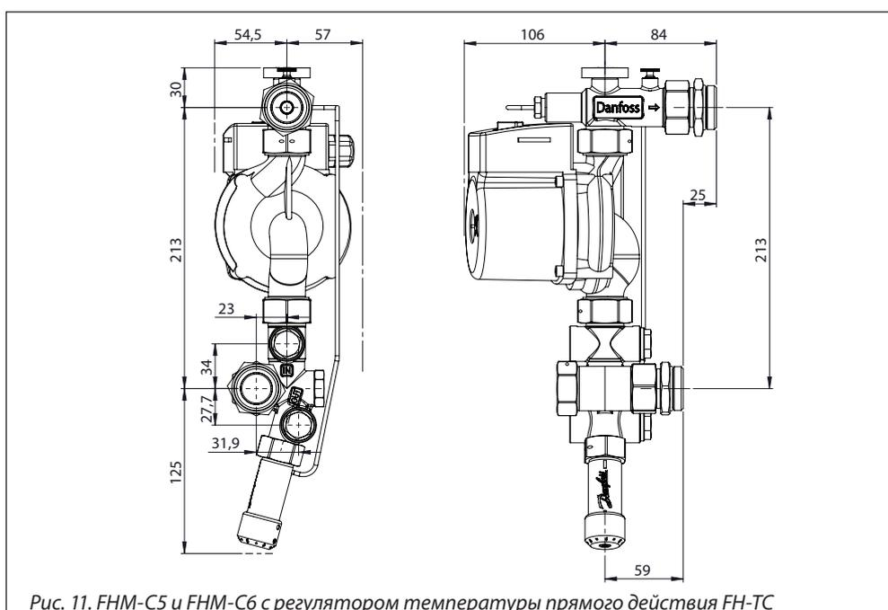
Рис. 11. FHM-C5 и FHM-C6 с регулятором температуры прямого действия FH-TC
