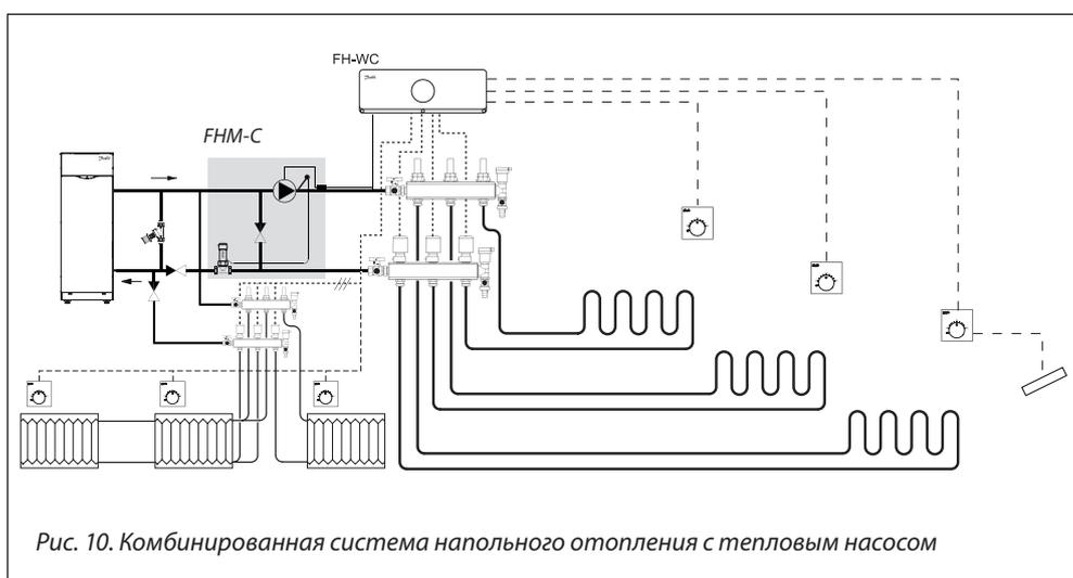
Рис. 10. Комбинированная система напольного отопления с тепловым насосом
