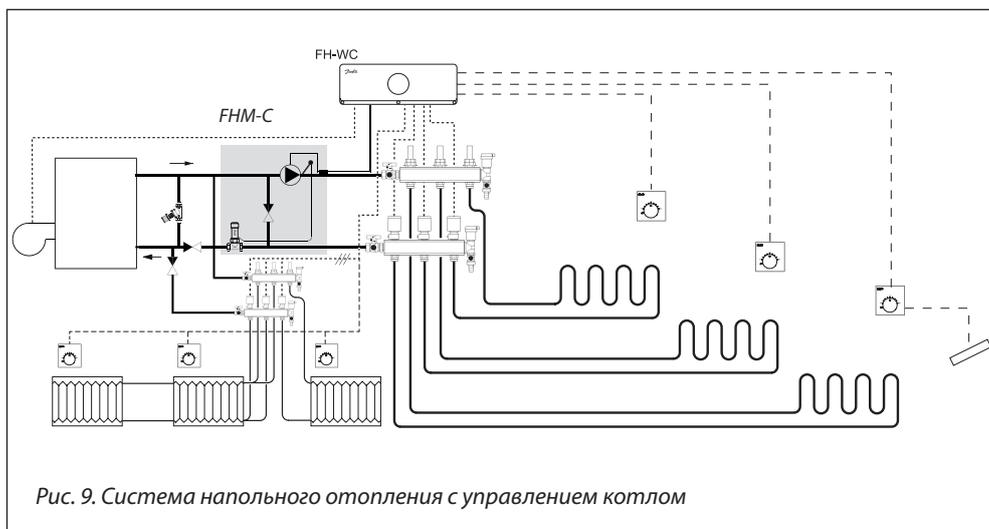
Рис. 9. Система напольного отопления с управлением котлом
