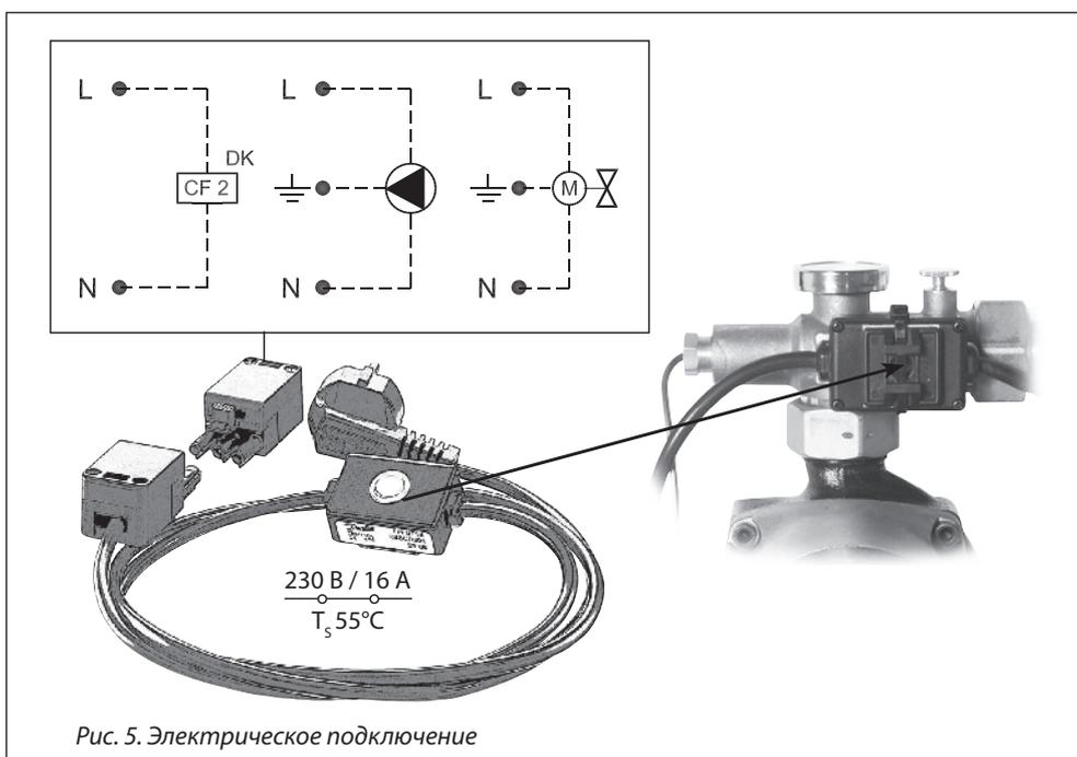
Рис. 5. Электрическое подключение
