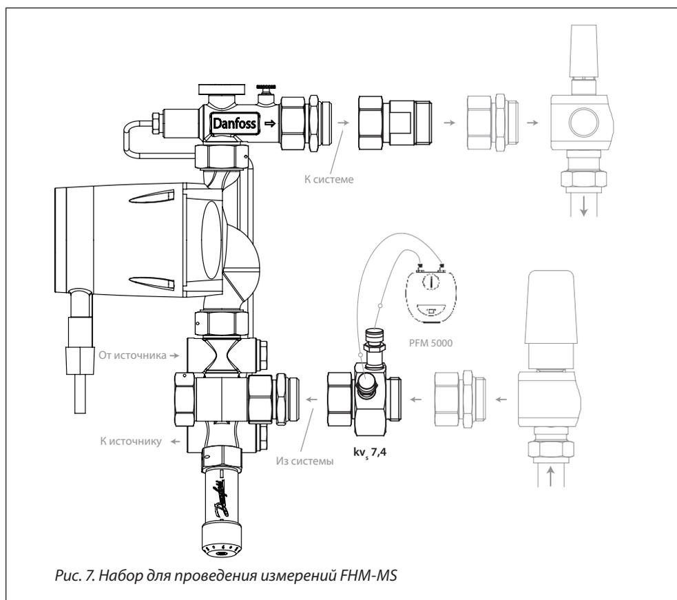
Рис. 7. Набор для проведения измерений FHM-MS
