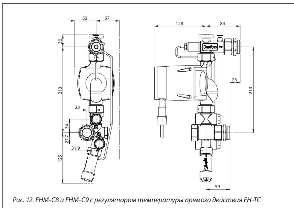
Рис. 12. FHM-C8 и FHM-C9 с регулятором температуры прямого действия FH-TC
