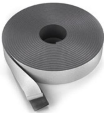
Лента самоклеящаяся Energoflex® Super SK из вспененного полиэтилена обладает низким коэффициентом теплопроводности ( $\lambda_0=0,035$  Вт/(м·°C)) и предназначена для изоляции фитингов, арматуры и труднодоступных участков трубопроводов в системах отопления и водоснабжения, а также для уплотнения различных соединений.
