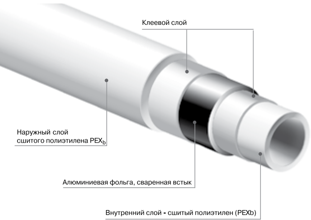
Рисунок 1. Структура трубы PE-Xb/Al/PE-Xb
