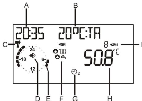
**!** Из-за погрешностей температурных датчиков между различными температурными показаниями возможны +/- 2K(2°C) отклонения. Температуры, которые изменяются быстро, могут иметь более высокие отклонения в течение коротких периодов из-за различного поведения во времени различных датчиков.
