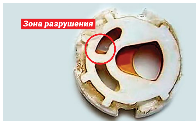
Рис. 11 Зона возможного разрушения керамической пластины смесителя
