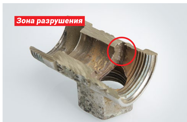
Рис. 13 Сквозное разрушение корпуса редуктора
