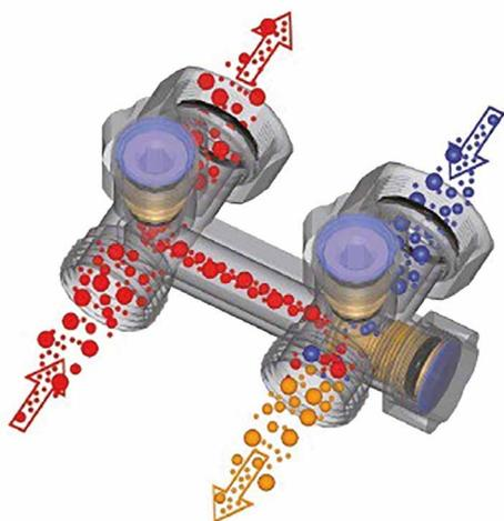
Распределители для отопительных приборов со встроенными вентилями производятся с настенными и напольными соединениями, они обладают двойной герметичностью с внешней стороны, и закрывание затвора обеспечивается за счет уплотнительных прокладок o-ring.
