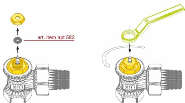
Шток управления выполнен из нержавеющей стали AISI 316. Герметичность штока обеспечивается за счет пары уплотнительных прокладок o-ring из EPDM пероксидной полимеризации, а герметичность шпинделя обеспечивает 1 кольцевая прокладка o-ring из EPDM пероксидной полимеризации. Запорная прокладка на затворе
