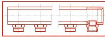
Распределительные коллекторы с предустановленными соединениями RD 900
