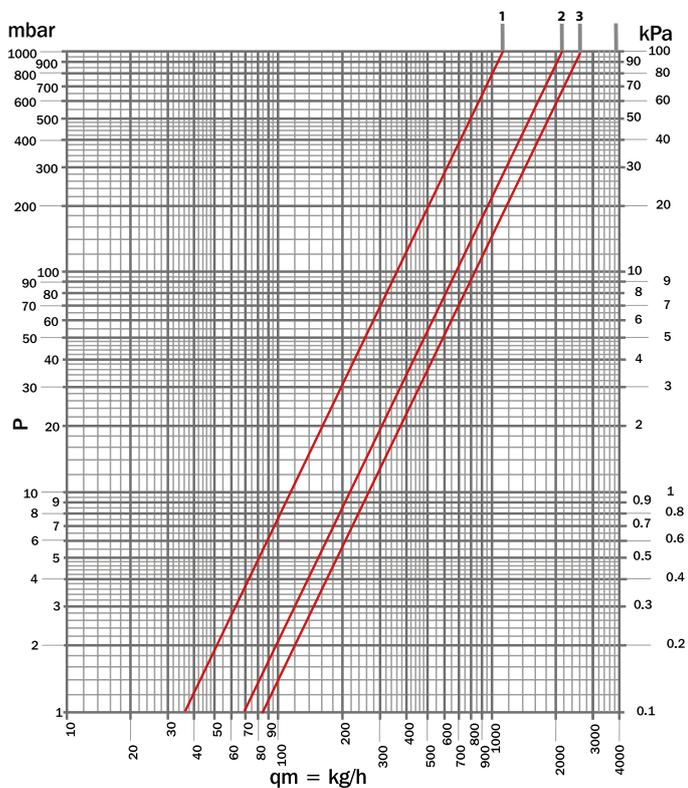
В вентилях серии М 88 в положении максимально открыто байпас перекрывается, и 100% напора данного контура поступает в отопительный прибор (см. рисунок). Байпас открывается по возрастающей по мере закрывания затвора (см. ниже).
