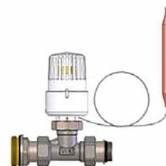
Этот клапан управляется термостатической головкой с капиллярным датчиком, который поддерживает заданную температуру на коллекторе подачи контура теплого пола, смешивая теплоноситель, поступающий из высокотемпературного контура с теплоносителем, циркулирующим в системе напольного отопления.
