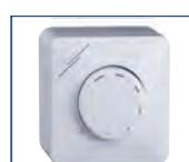
Регуляторы PSF и PSS-M предназначены для управления скоростью вращения EC-двигателей вентиляторов. Регуляторы позволяют плавно регулировать выходной сигнал в диапазоне 0–10 В. Регулятор PSS-M снабжен настраиваемыми ограничителями минимального и максимального выходного сигнала (скорости), регулятор PSF имеет дополнительные контакты, которые размыкаются в нулевом положении ручки. Регуляторы выпускаются для настенного/скрытого монтажа. Корпус регуляторов изготовлен из АБС-пластика.
