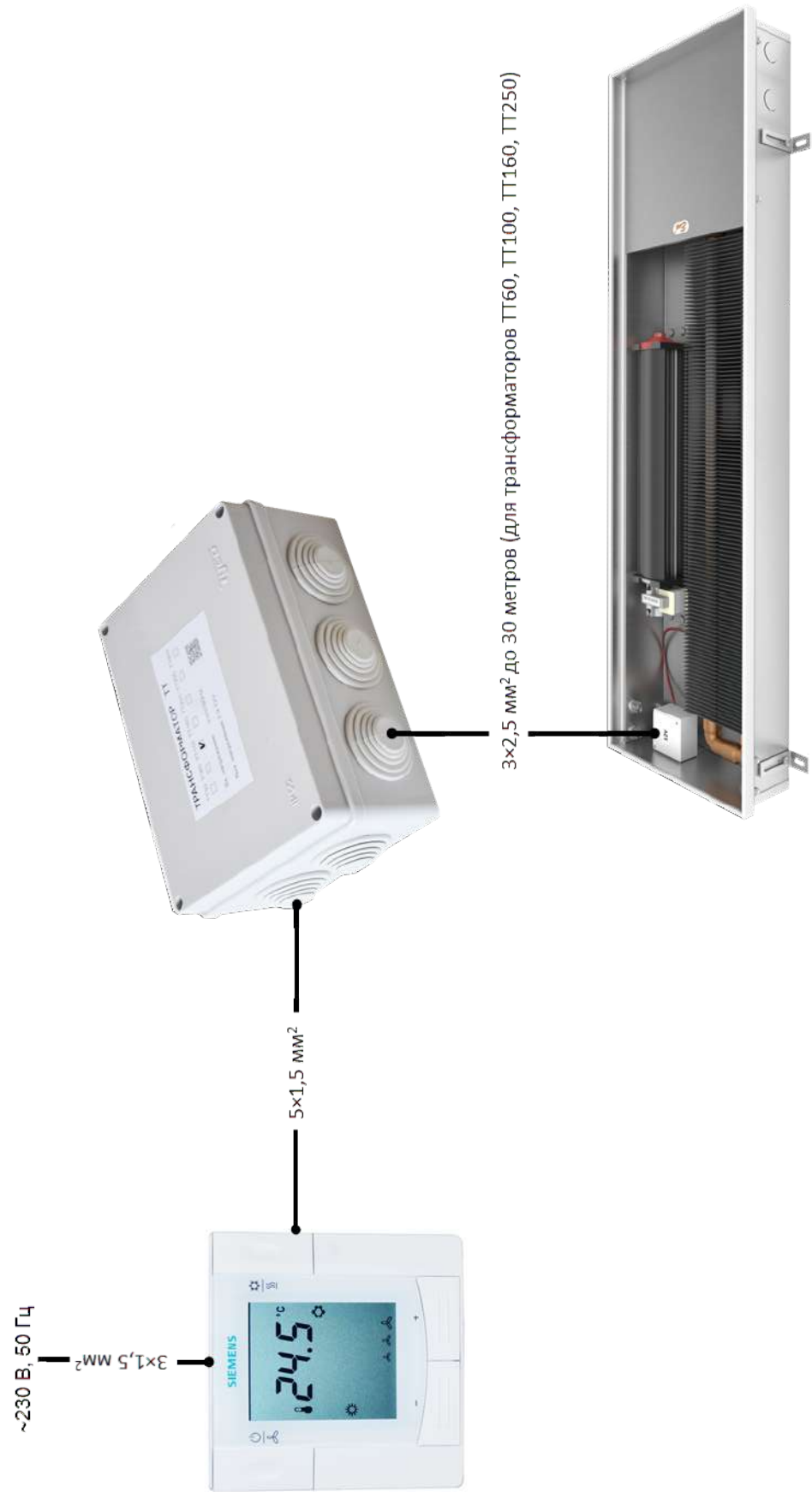
Схема D: Ручное/автоматическое трёхскоростное регулирование. Схема проводки. (при подключении контроллера температуры Siemens RDF310)
