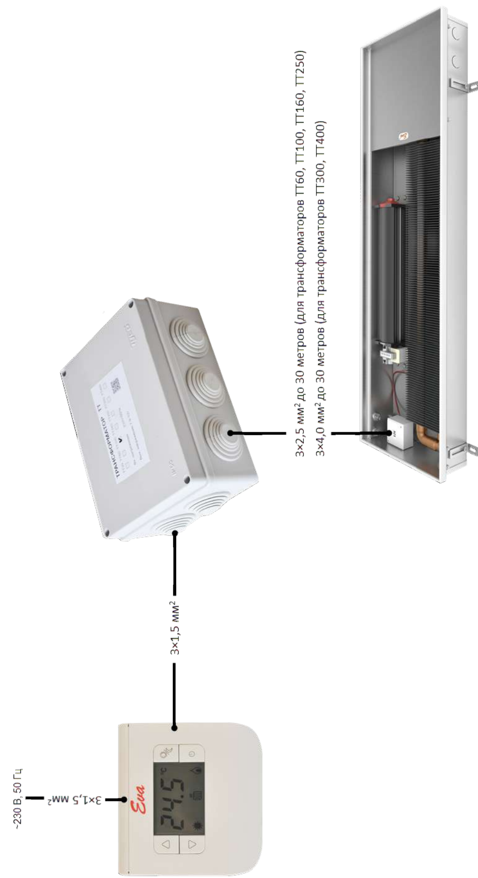
Схема А: односкоростное регулирование (схема проводки)
