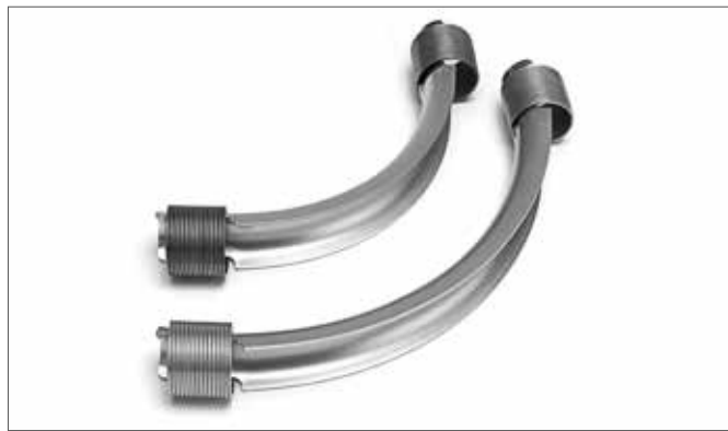
Рис. 8-5 Фиксаторы поворота (водоснабжение) (4 x Ø) – 90° и фиксаторы поворота (водоснабжение / отопление) (5 x Ø) – 90° для изгиба труб Ø 32
