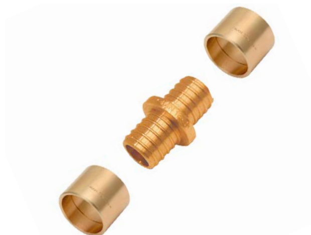
Рис. 49. Двухсторонний соединитель KAN-therm Push для труб PE-Xc и PE-RT диаметрами 12 × 2; 14 × 2; 18 × 2; 18 × 2,5; 25 × 3,5
