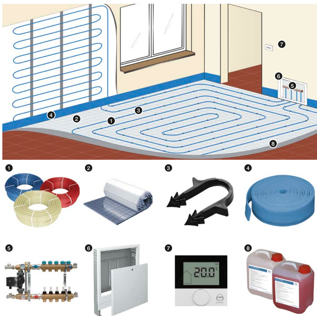
Рис. 46. Элементы панельно-лучистого отопления/охлаждения KAN-therm
