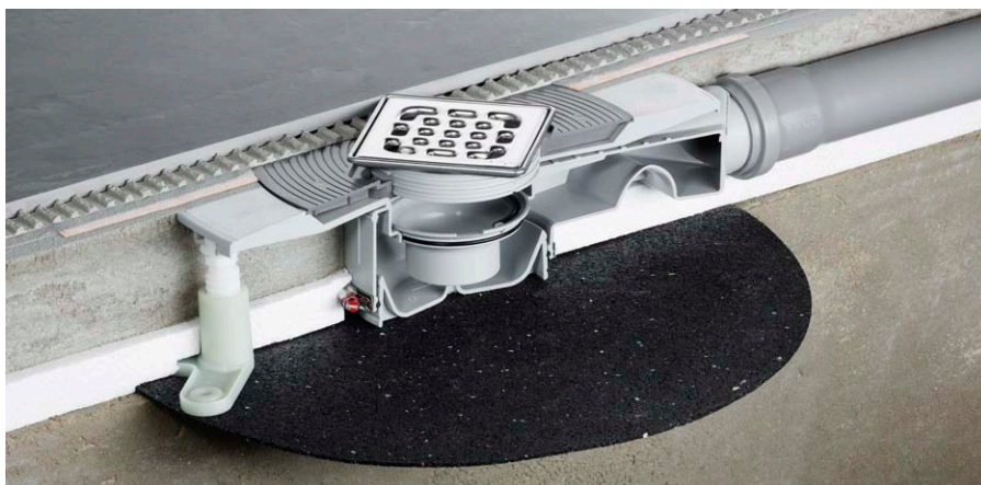
Трап Advantix Top надежно исключает эффект «срыва» гидрозатвора благодаря центральному каналу для воздуха и боковым накопительным зонам.
