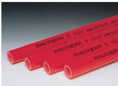
осуществлять быструю и простую укладку и обеспечивают высокую степень надежности. Основная составная часть всех систем – **труба RAUTHERM S из высококачественного сшитого полиэтилена RAU-VPE (PE-Xa)** устойчива к воздействию давления, прочна и непроницаема для кислорода в соответствии с DIN 4726.
