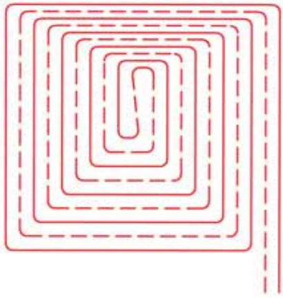
1 Рис. 79: Метод укладки улитка с более плотной укладкой в граничной зоне
