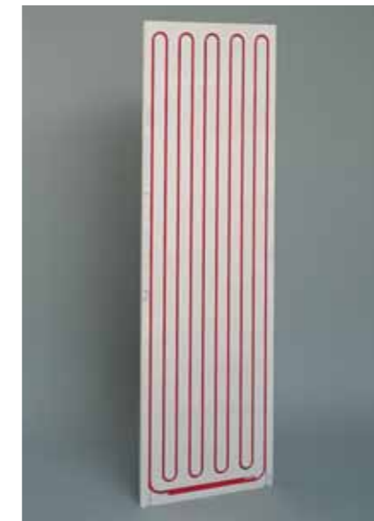
3 Рис. 20: KES-панель большая ШУ 60 Длина панели: 200 см Ширина панели: 62 см Толщина панели: 18 мм Шаг укладки: 60 мм Вес: 24,18 кг Длина уложенной трубы: 20,0 м
