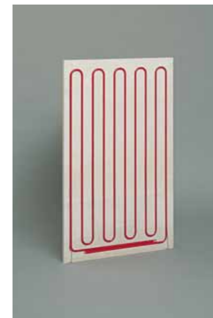
3 Рис. 21: KES-панель малая ШУ 60 Длина панели: 100 см Ширина панели: 62 см Толщина панели: 18 мм Шаг укладки: 60 мм Вес: 12,09 кг Длина уложенной трубы: 10,0 м
