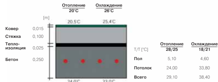
5 Рис. 46: Конструкция плиты 1
