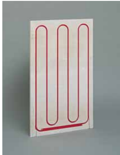
3 Рис. 23: KES- панель большая ШУ104 Длина панели: 100 см Ширина панели: 62 см Толщина панели: 18 мм Шаг укладки: 104 мм Вес: 12,09 кг Длина уложенной трубы: 6,5 м
