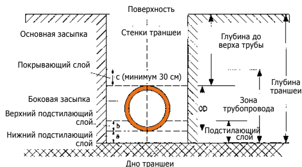
Рис. 3 Устройство траншеи
