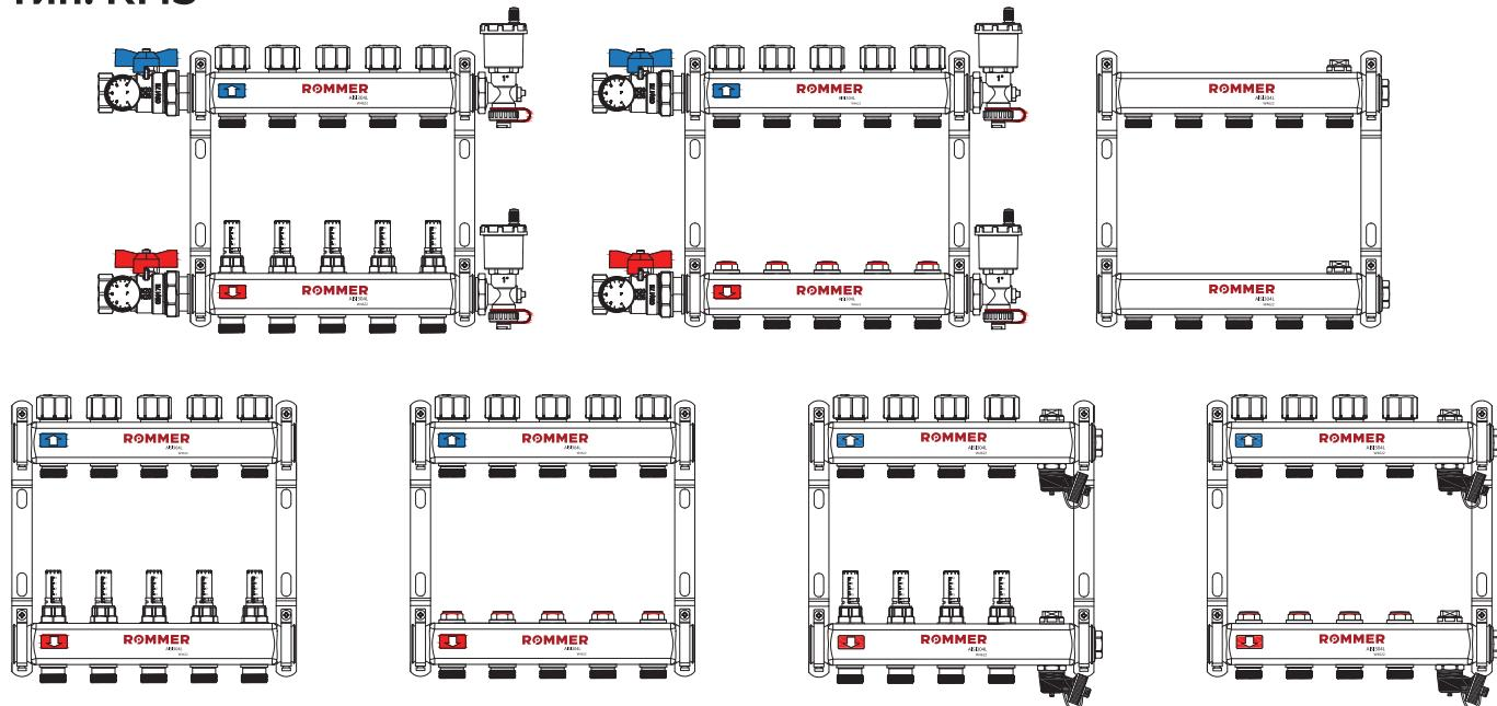
КОЛЛЕКТОРНЫЕ РАСПРЕДЕЛИТЕЛЬНЫЕ БЛОКИ RÖMMER – предназначены для улучшения производительности систем отопления зданий, за счет равномерного распределения теплоносителя по контурам. Коллекторы могут использоваться как в домах индивидуальной застройки, так и в системах отопления многоквартирных жилых зданий, где требуется распределение потока теплоносителя между помещениями на этаже многоквартирного многоэтажного жилого или административного здания.
