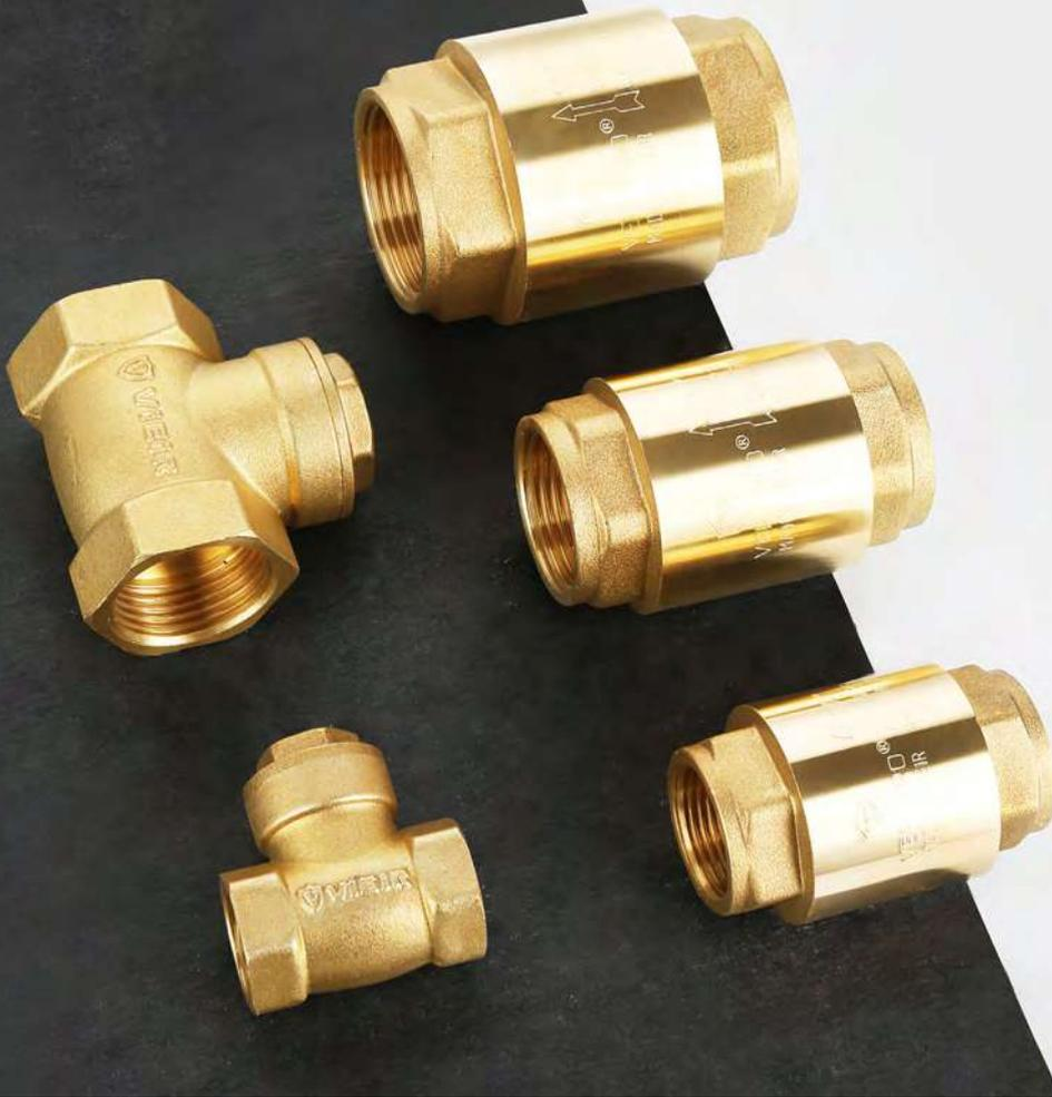
Клапан обратный пружинный применяется в гидравлических системах с целью перемещения рабочей среды только в одном направлении, указанном стрелкой на корпусе клапана, без возможности образования обратного тока рабочей среды в следствие отсутствия напора или образования встречного напора возникающего при работе циркуляционных насосов работающих в закрытой системе.
