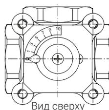
Поворотные регулирующие трехходовые смесительные клапаны предназначены для регулирования расхода теплоносителя в системах отопления и охлаждения (отопление с использованием радиаторов, отопление в полах и других поверхностных системах). Основное назначение клапана – смешение или разделение потоков рабочей среды:
