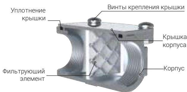
Фильтр газовый Vieir VRQ25, VRQ26 предназначен для установки на линии подачи газа для настенных или напольных котлов или бытовых газовых водонагревателей, основная функция изделия заключается в очистке транспортируемой среды от механических примесей, окалины, металлической стружки и твердых частиц.
