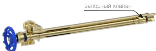
Конструктивно - запорная часть крана находится в отапливаемом помещении, а вентиль и излив с внешней стороны здания, на улице.
