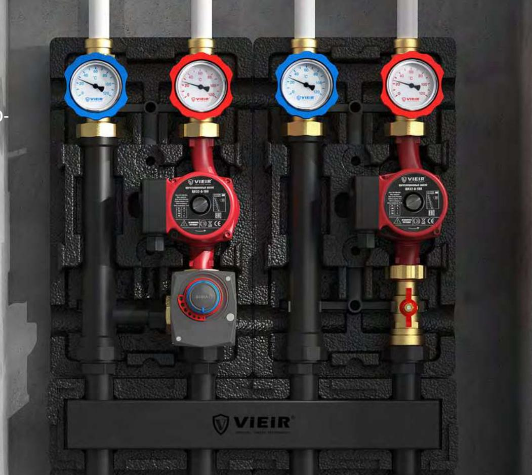
Сервопривод (электропривод) поворотный предназначен для автоматического управления трёх и четырёхходовыми смесительными клапанами с помощью термостата или контроллера. Управление – импульсное. Напряжение питания – 220 В. Возможно переключение на ручное управление. Привод подключается к клапану с помощью переходной втулки (входит в комплект поставки).
