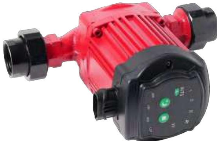
Циркуляционный насос представляет собой специализированный насосный агрегат с «мокрым» ротором, который предназначен для создания принудительной циркуляции жидкости в закрытых системах отопления при стабильном или слабо меняющемся расходе. Ротор мотора располагается непосредственно в перекачиваемой среде, ротор от статора отделяет гильза из нержавеющей стали, подшипники смазываются и охлаждаются
