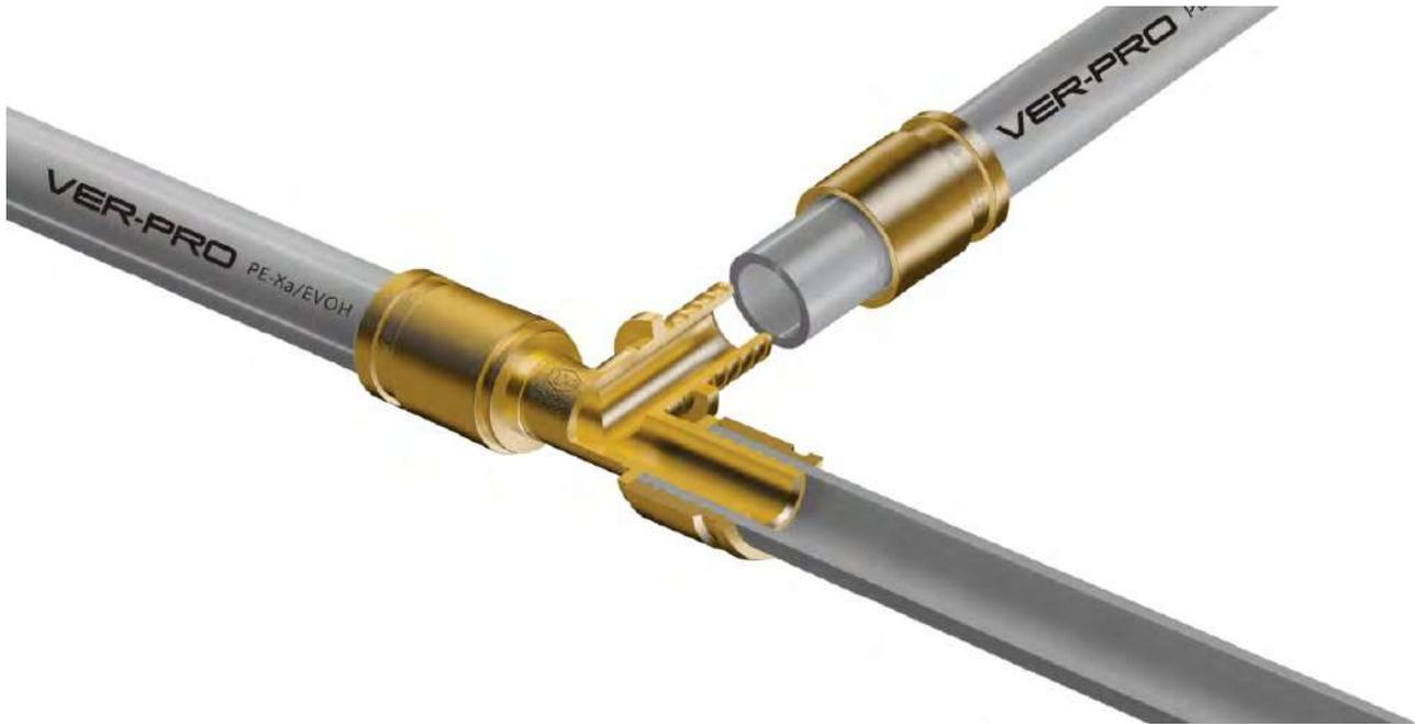
Аксиальные фитинги (с подвижной гильзой) VER-PRO предназначены для соединения полимерных и металлополимерных трубопроводов из труб PE-X и PE-RT (PE-X, PE-X/EVOH, PE-RT, PE-RT/EVOH, PE-RT/EVOH/ PE-RT) серии S3.2 (SDR7.4), используемых в системах питьевого и хозяйственно-питьевого водопровода, горячего и холодного водоснабжения, водяного отопления, систем снеготаяния, а также в качестве технологических трубопроводов, транспортирующих жидкости, не агрессивные к материалам труб и фитингов.
