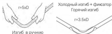
Минимальный радиус изгиба с пружинным вкладышем / с трубогибом составляет 3xd, без вспомогательных средств 5xd.
