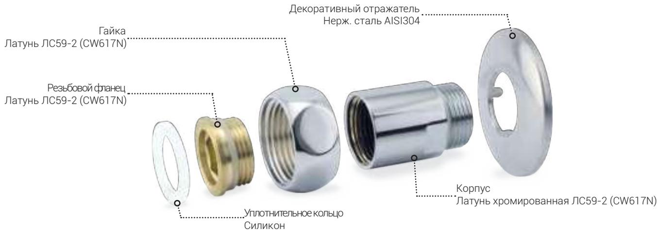
Фитинги и комплектующие для полотенцесушителей VIEIR предназначены для монтажа и комплектации полотенцесушителей. Применяются при монтаже систем с номинальным давлением до 16 бар и рабочей температурой до 100°C. Фитинги имеют дюймовую цилиндрическую резьбу по DIN ISO 228/1. В комплект фитингов входит декоративный отражатель и дополнительно уплотнительный материал из силикона, что позволяет создавать разборные соединения без применения дополнительного уплотнительного материала.
