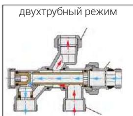
При установке на клапан VR321A термостатической головки с резьбовым присоединением M30x1.5 клапан будет автоматически поддерживать температуру воздуха в помещении на заданном уровне с точностью до 1°C.
