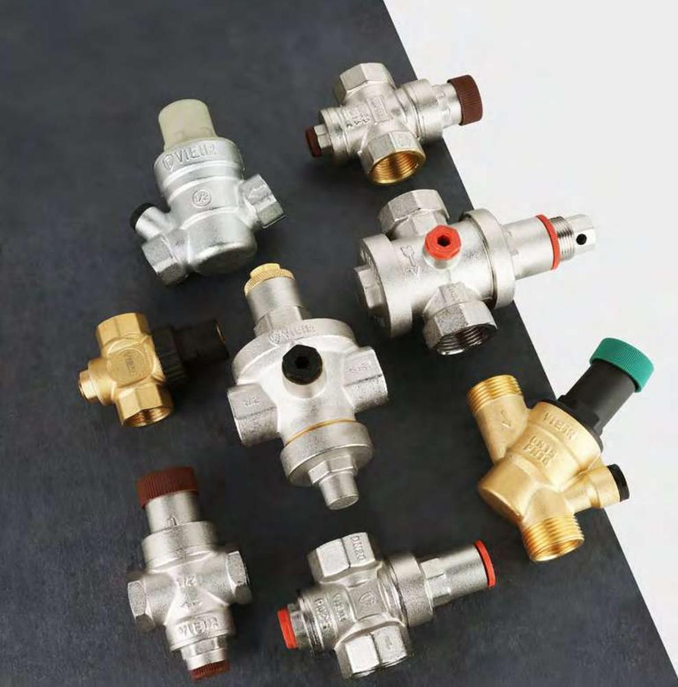
Редуктор давления применяется в системах бытового и промышленного водоснабжения для понижения давления рабочей среды и обеспечения стабильного (заданного) давления в инженерных системах на выходе (с возможностью регулировки) в динамическом и статическом режимах независимо от изменения давления на входе.
