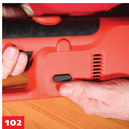
102 Рычаг переключения направления поршня переводится в положение реверса. При нажатии кнопки возврата поршень возвращается в исходное положение
