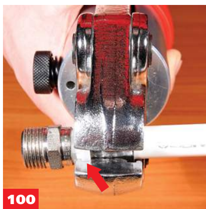
100 При установке насадки на фитинг следует обратить внимание на то, чтобы буртик пластиковой обоймы фитинга плотно вошел в соответствующую канавку насадки
