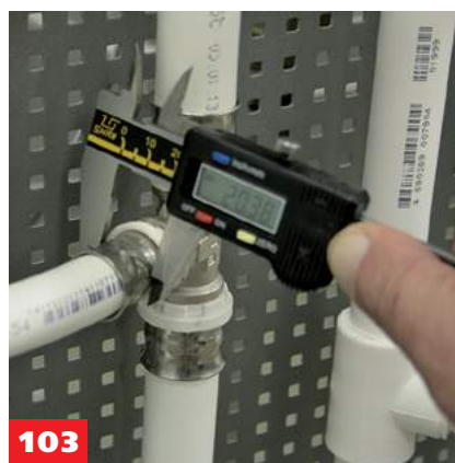
103 Качество выполненного пресс-соединения проверяется замером штангенциркулем максимального диаметра зоны обжатия. Он должен быть не более значений: 16 - 16,7; 20 - 20,7; 26 - 26,7; 32 - 32,7; 40 - 40,8
