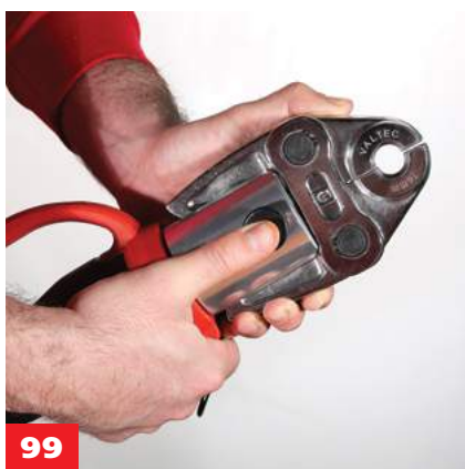
99 Пресс-насадка закрепляется на инструменте с помощью фиксирующего пальца
