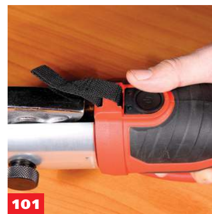
101 Нажатием на пусковую кнопку инструмента достигается полное смыкание губок насадки. При полной опрессовке звук работы двигателя меняется (происходит автоматический переход в режим холостого хода)
