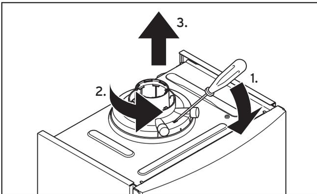
1. Вставьте отвертку в щель между измерительными шуцерами.
