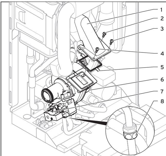
1. Снимите воздухозаборную трубу.
