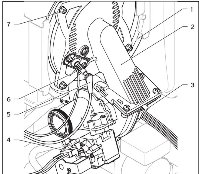
1. Наденьте термо-компактный модуль (2) на теплообменник (1).
