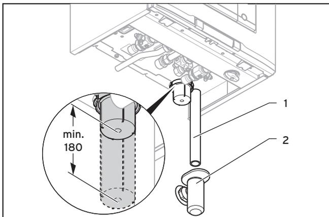
В результате сгорания топлива в изделии образуется конденсат. Линия отвода конденсата отводит конденсат через сливную воронку к присоединительному патрубку канализации.
