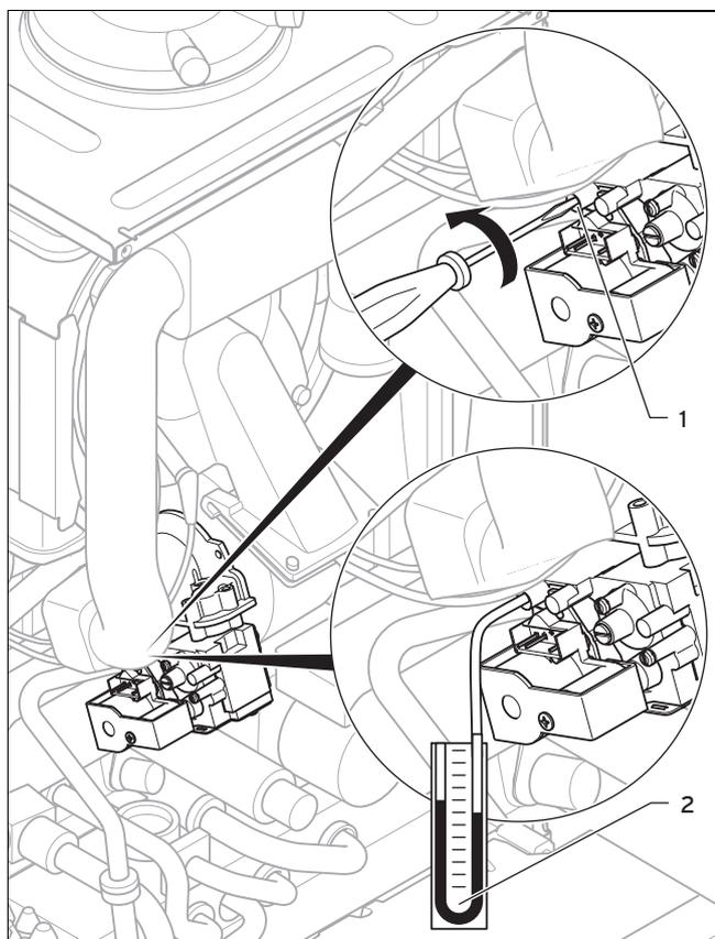
2. С помощью отвертки открутите уплотнительный винт измерительного штуцера (1) (левый винт) на газовой арматуре.
