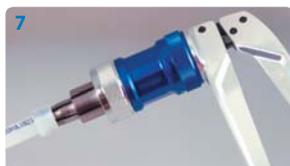
Выньте сегменты головки из трубы и повторите операцию расширения. Внимание! Головка должна поворачиваться автоматически после каждого расширения. Вам не нужно поворачивать сам инструмент. Количество расширений не должно превышать максимально допустимого
