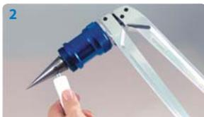
Прикрутите к расширительному инструменту насадку-вращатель. Смажьте конус насадки-вращателя графитовой смазкой Uronor
