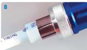
Расширьте трубу с кольцом до тех пор, пока торец трубы не упрется в торец расширительной головки
