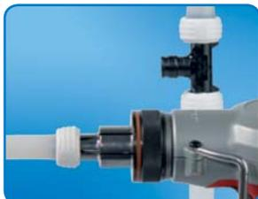
Расширьте конец трубы расширительным инструментом Uronor
