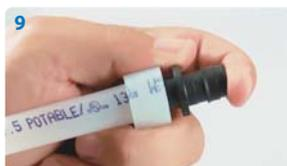
Быстро выньте инструмент из трубы и установите фитинг Q&E. Конец трубы при этом должен упереться в упор фитинга
