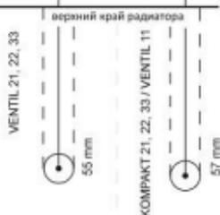
1. Нанести на стену две горизонтальные параллельные линии длиной L равной номинальной длине радиатора.
