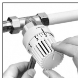
1 Photo 1: Retirer la poignée manuelle à l'aide de l'outil réf. 1989100 ou une pointe, par ex. l'embout d'un stylo. Enfoncer la pointe dans le trou sur la face inférieure du thermostat et par une simple rotation vers la droite jusqu'en butée, on retire facilement la poignée (voir photo 16).
