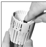
5 Photo 5: Pour limiter la valeur de consigne supérieure, par x. sur chiffre «4» (environ 24 °C), faire glisser le deuxième clip dans la nervure derrière le chiffre «4». (La nervure en face du chiffre «4» reste libre.)
