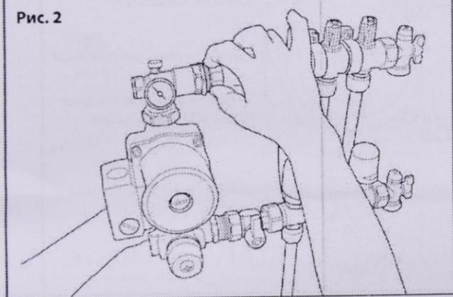
Закрутить верхнюю и нижнюю накидные гайки поочередно по несколько оборотов (рис. 2) до упора.
