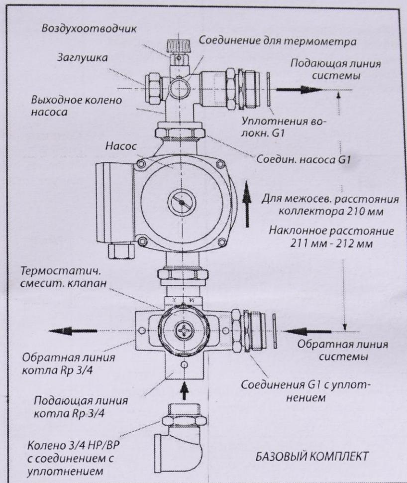
Подходит для тепловой нагрузки до 15 кВт. Этот терmostатический смесительный узел для теплых полов с насосом предназначен для прямого подсоединения к отопительным коллекторам с межосевым расстоянием 210 мм и поставляется в полностью собранном виде в левостороннем стандартном варианте с резьбовыми соединениями HP G1 с накидными гайками и торцевыми уплотнениями.
