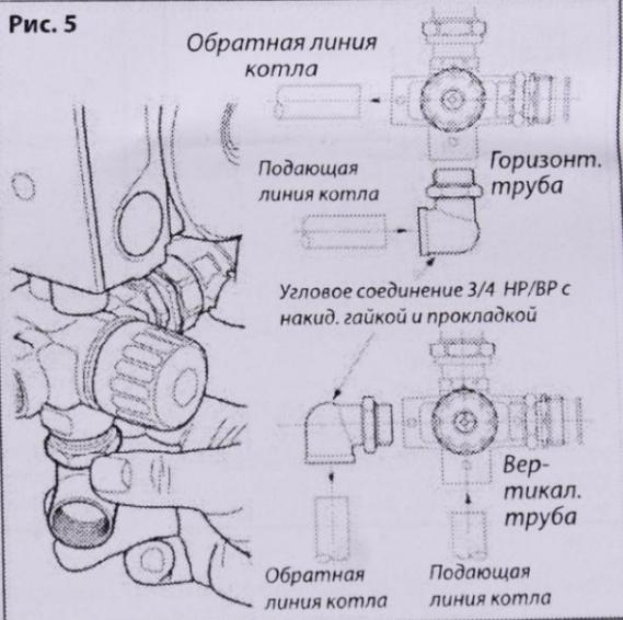
В случае вертикальной трубы следует подсоединить колено к регулирующему клапану обратной линии, а в случае вертикальной трубы следует подсоединить колено к регулирующему клапану подающей линии (рис. 5).
