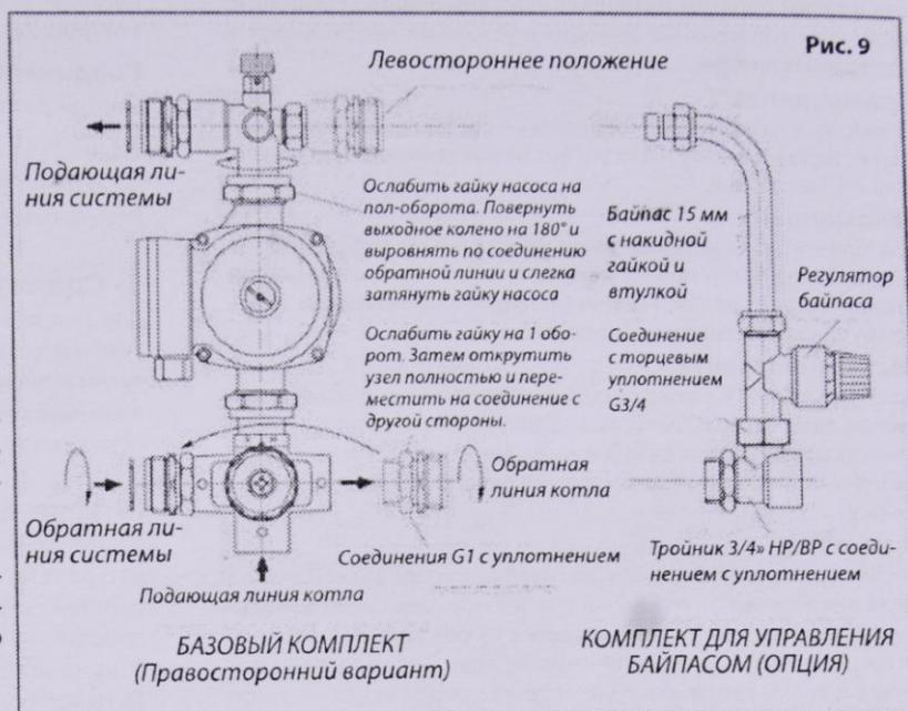
Следовать процедуре монтажа (**см. раздел 1**), но с учетом правосторонней установки. После монтажа прочно затянуть гайку G1 на выходе насоса с помощью клемщет.
