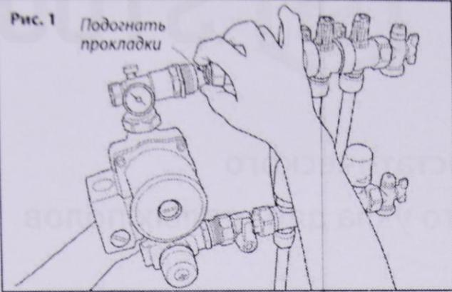
Подвести узел к соединениям, разместив сначала нижнее (*обратное*) соединение (рис. 1), затем повернуть верхнее (*подающеее*) соединение до параллельного выравнивания и протолкнуть весь узел вперед до момента, когда накидные гайки дойдут до резьбы.
