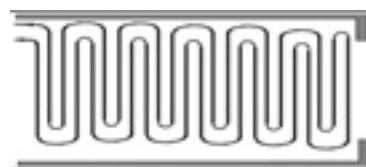
Рис. 17а. Контур, уложенный спиралью в форме меандра, применяется в случае длинных и узких полов с многочисленными разделительными швами.
