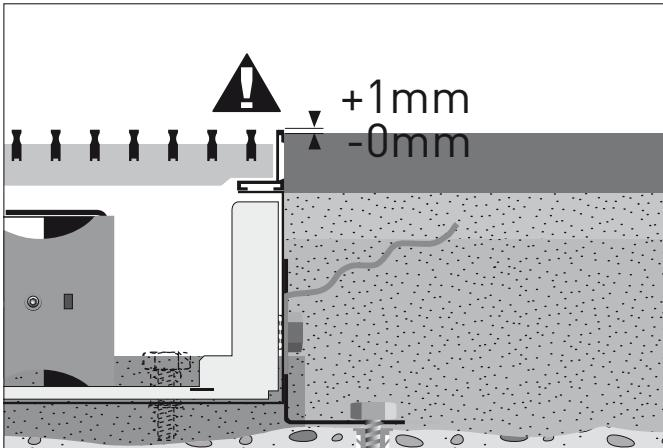
**5** Vulbeton aanbrengen / Poser la chape
