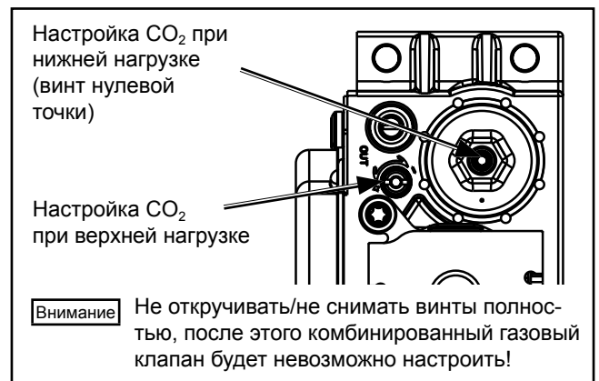
Комбинированный газовый клапан
