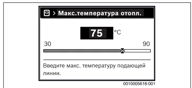
Рис. 25 Установка максимальной температуры подающей линии
