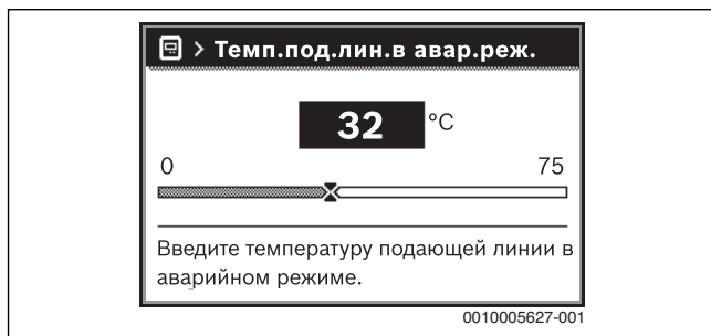
Рис. 42 Температура подающей линии для аварийного режима
