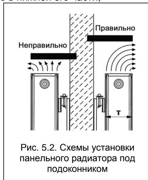
Рис. 5.2. Схемы установки панельного радиатора под подоконником
