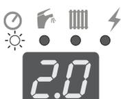
Нажмите кнопку **MODE**, давление (бар) нагревательной воды циркулирующей в системе на 30 секунд появится на дисплее. Одновременно осуществляется индикация у символа ⌚ - светодиод светит.
