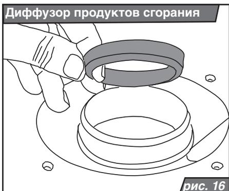
**Предупреждение:** При превышении длины, указанной в таблице 1, необходимо убрать диффузор продуктов сгорания (заслонку) из выхода вентилятора (рис. 16).
