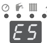
Нажимайте кнопку **MODE** пока на дисплее появится буква **E** с параметром от 0 до 9. Выбор погодной характеристики производится с помощью кнопок  $\leftarrow$   $\rightarrow$ . Крутизна характеристики возрастает
