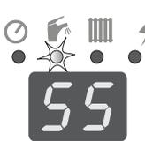
Нажимайте кнопку **MODE** до тех пор, пока у символа ☀ не начнёт мигать светодиод. Нажатием кнопки **-** **+** установите желаемый параметр температуры горячей воды для хозяйственных нужд. Диапазон настройки: --, 38, 39, 40, 41, 42, 45, 50, 55, 60, 65, 70 °С.
