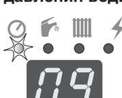
При снижении давления воды в системе отопления ниже значения 0,8 бар или при повышении на значение более 2,5 бар - мигает светодиод у символа ⌚. Котёл всё ещё функционирует, необходимо отрегулировать давление на рекомендуемое значение 1 - 2 бар.
