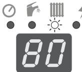
После включения котла главным выключателем на дисплее котла изображается актуальная температура нагревательной воды. Это состояние показывается светодиодом у символа
