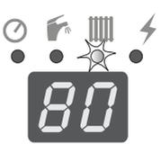
Нажимайте кнопку **MODE** до тех пор, пока не начнёт мигать светодиод у символа ☀. Нажатием кнопки **-** **+** установите желаемый параметр. Диапазон настройки: --, 38, 40, 42,
