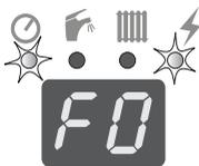
Падение давления нагревательной воды в системе (ниже значения 0,6 бар). Котёл автоматически отключается из режима работы – мигает
