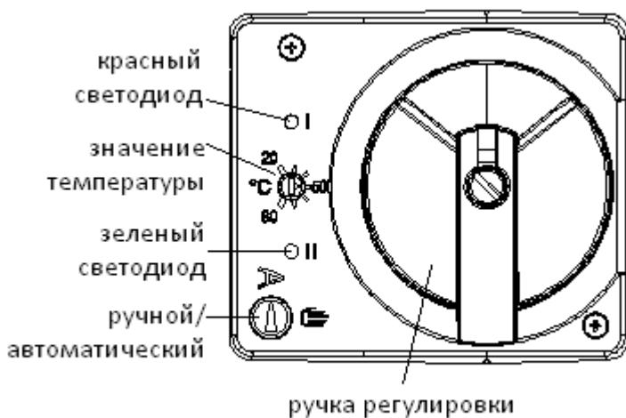
Значение температуры можно регулировать с помощью небольшой отвертки ( см. раздел 9.1 Регулировка значения температуры). Два светодиода показывают фактическое состояние операции или произошла ошибка, ( см. раздел 9.2 светодиодных дисплеев и главу 11. « Ошибки и устранение неисправностей » ). С помощью отвертки сервопривод может быть переключен из автоматического режима, в ручной.
