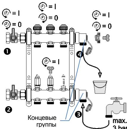
Закройте шаровые краны ①+②. Подключите шланг для наполнения и промывки к сливному крану концевой группы ③ подающего патрубка; сливной кран ④ обратного патрубка должен быть полностью открыт!
