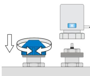
После окончания регулировки защитный колпачок или сервопривод устанавливаются на регулирующий клапан, препятствуя, таким образом непроизвольной перенастройке или загрязнению клапана.
