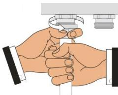
Закрутите вручную накидную гайку. Пластиковая, медная или металлопластиковая труба должна быть вставлена при этом до упора.
