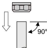
Разрежьте пластиковую, медную или металлопластиковую трубу под прямым углом, зачистите и откалибруйте ее. Наденьте накидную гайку фитинга на трубу.
