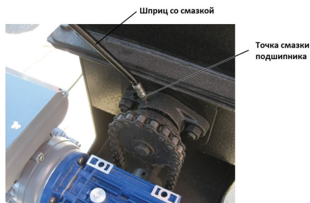
Рис. 8. Смазка подшипников шнековой подачи.
