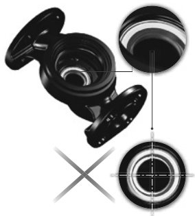
Рис. 16 Неправильно выровненная система уплотнений
