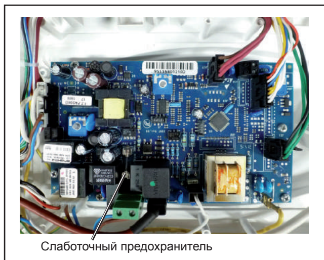
Рис. Замена предохранителей
