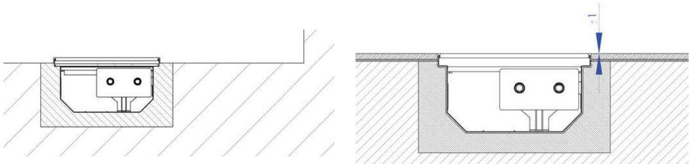
**Рис. 22:** Очень важно, чтобы вся внешняя поверхность конвектора была позже залита классическим бетоном, вплоть до окончательной высоты черного пола. Конвектор сейчас забетонирован до черного пола, который готов к укладке финального покрытия (паркет, плитка и т.д.).
