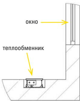
Рис. 2: Конвектор с теплообменником, установленным по направлению «от окна», как основной источник тепловой энергии
