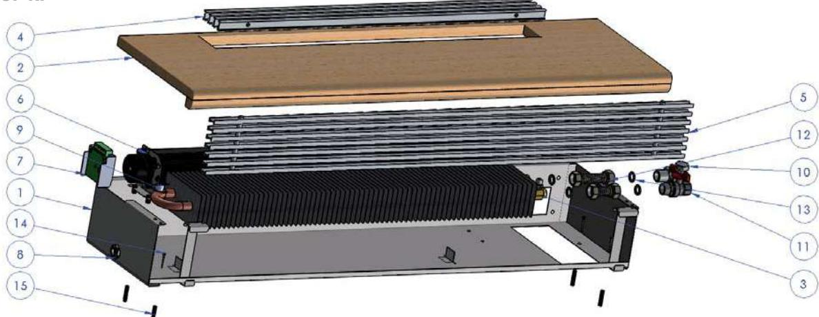
1. КОРПУС КОНВЕКТОРА - Корпус из нержавеющей стали для установки в отверстие подоконника.
