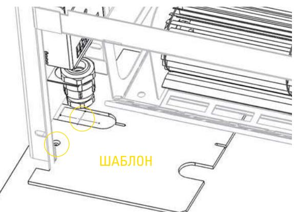
**Рис. 6:** На противоположной стороне разметить при помощи шаблона вход кабеля в том случае, если конвектор оснащен вентиляторами, и отверстия для крепления конвектора к полу.
