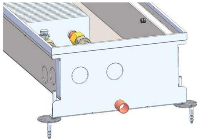
**Рис. 10:** Возможна установка дренажной трубы с другой стороны конвектора, чем показано на рисунке, в зависимости от типа.
