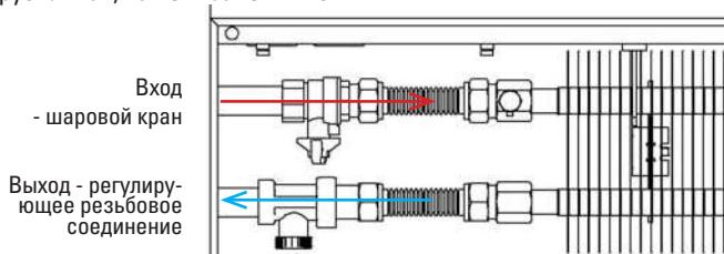
Рис. 26: Прямое подключение воды – стандартное исполнение (стандартные принадлежности).
