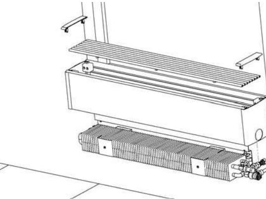
**Рис. 12:** Установить раму конвектора, решетку и крышки.
