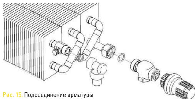
Рис. 15: Подсоединение арматуры для отопительного прибора LP.
