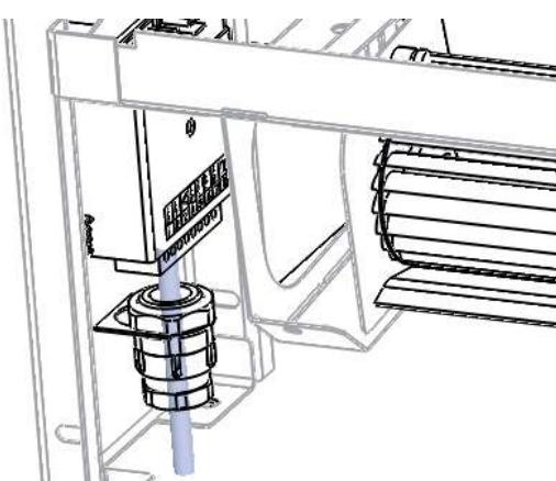
**Рис. 12:** У конвекторов с вентиляторами подсоединить кабель через кабельный ввод к блоку управления в соответствии с руководством «Регулирование» на основе выбранного вида регулирования. Проверить работу вентилятора.
