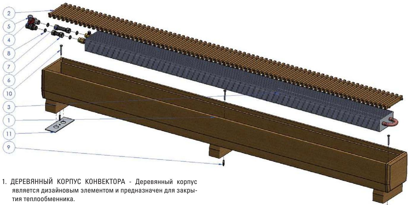
1. ДЕРЕВЯННЫЙ КОРПУС КОНВЕКТОРА - Деревянный корпус является дизайновым элементом и предназначен для закрытия теплообменника.
