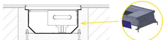
**Рис. 8:** Полный пол – теплоизоляция для внутрипольного конвектора без вентилятора – для защиты пола со стороны теплообменника
