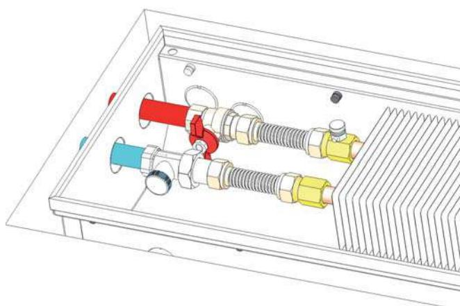
**Рис. 19:** Подключить подводящие и отводящие трубы. См. п. 6
