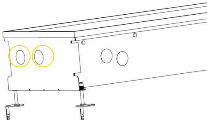
Рис. 14: Удалите необходимые перфорированные крышки отверстий для подключения теплоносителя
