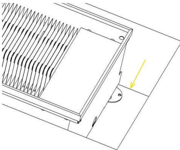
Рис. 12: Установить конвектор в монтажное отверстие, и разметить места для сверления отверстий для крепления пяты.
