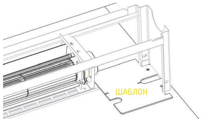
**Рис. 4:** Снять крышку конвектора с пластмассовой крышкой и решеткой. Установить конвектор в требуемое положение. Положить шаблон на пол, как показано на рисунке, в местах, где будет вход и выход горячей воды. Разметить отверстия для крепления конвектора к полу.
