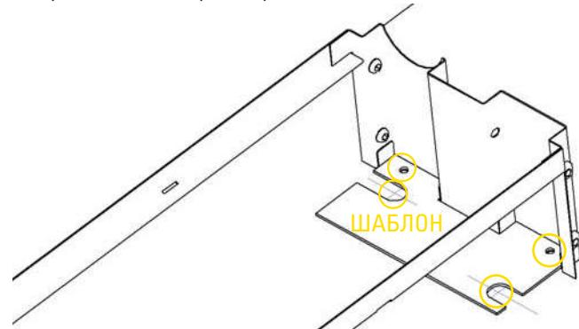
Рис. 5: На полу обозначьте вход/выход теплоносителя и отверстия для крепления конвектора. Вход направлен к нижнему выходу теплообменника, на который ставится терmostатический клапан. На выход – верхняя трубка – устанавливается регулирующее резьбовое соединение.
