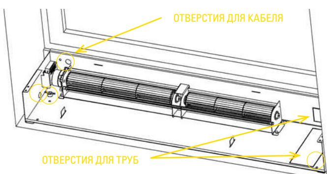
**Рис. 7:** Снять доску подоконника и решетки. Вынуть теплообменник и установить конвектор в нужное положение. Разметить отверстия для крепления конвектора, подвода воды и кабеля. Отверстия для крепления могут быть снизу или с задней стороны корпуса конвектора.
