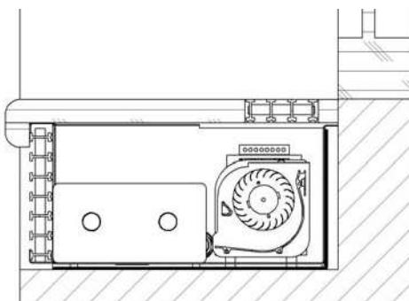
**Рис. 5:** Антивибрационная пленка для внутреннего конвектора с вентилятором. Она предназначена для снижения шума шагов, а также других возможных вибраций, и применяется по всему внешнему периметру конвектора.
