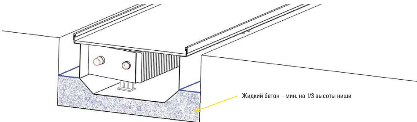
**Рис. 21:** Как минимум, 1/3 высоты конвектора осторожно залить жидким гравийным бетоном или ангидридной смесью для подавления шума до минимума. При плохом бетонировании дна конвектор с вентилятором могут резонировать!
