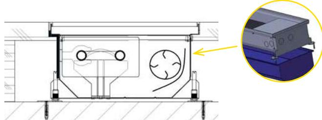
**Рис. 7:** Пустотелый пол – антивибрационная пленка для внутрипольного конвектора с вентилятором. Она предназначена для снижения шума шагов и гашения вибраций вентилятора, и в основном применяется по всему внешнему периметру конвектора.
