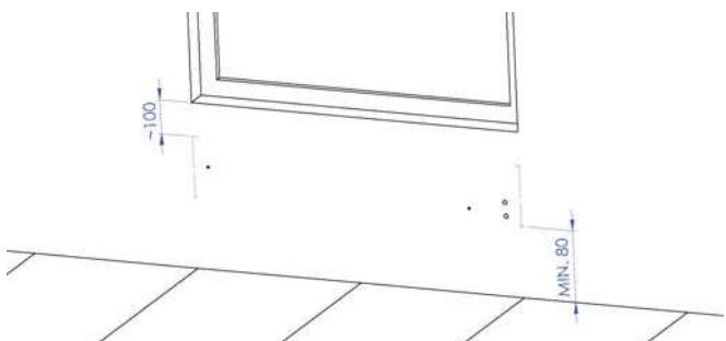
**Рис. 4:** Наметьте положение отопительного прибора. Руководствуйтесь размерами в таблице для монтажа – см. таблица 2. Отметить вход / выход воды, крепежные отверстия для несущей детали конвектора или ввода электропитания. Соблюдайте принципы, изложенные в п. 4.2 (положение конвектора).
