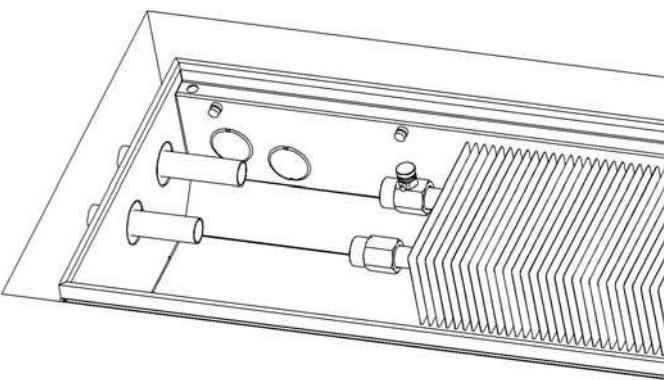
Рис. 15: Установить конвектор в монтажное отверстие, подвести трубы теплоносителя.
