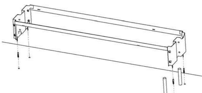
**Рис. 8:** Установить дюбеля и установить несущую раму конвектора. Зафиксировать конвектор в подготовленных отверстиях при помощи шурупов.
