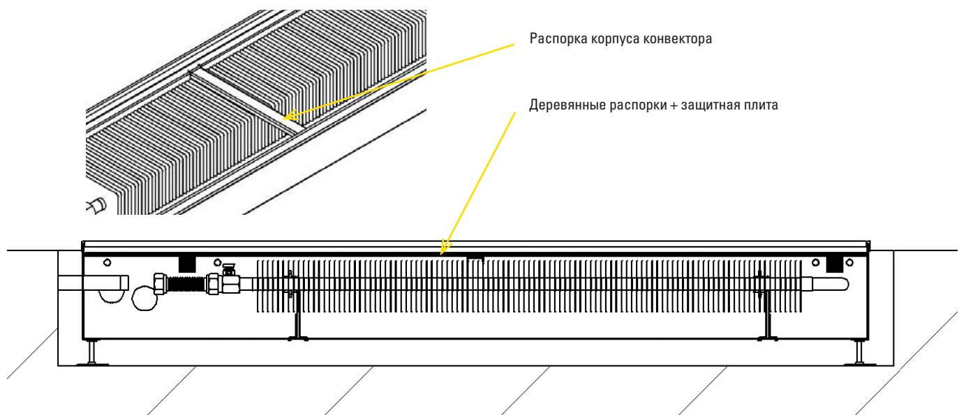
**Рис. 22:** Чтобы избежать загрязнения ниши во время бетонирования, **убедитесь в том, что** все отверстия внутри ниши заделаны! Установить в нишу конвектора распорки короба и деревянные распорки вместе с древесноволокнистой защитной плитой конвектора.
