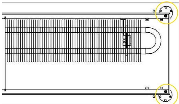
**Рис. 16:** Прикрепить конвектор при помощи фиксирующих пята к подготовленным дюбелям. Пяты зафиксировать быстротвердеющим бетоном.
