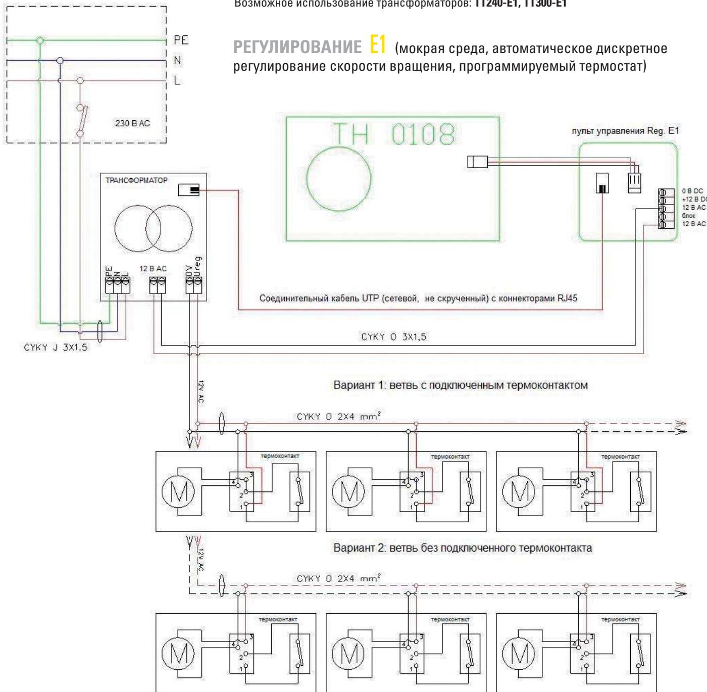
Сечения проводов выбираются в зависимости от токовой нагрузки и длины подводящих проводов. В случае использования здесь указанных сечений проводов максимальное допустимое расстояние между конвектором и трансформатором составляет 15 м.
