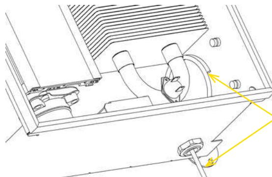
**Рис. 17:** В установленный конвектор подвести силовой кабель для двигателя. По причинам безопасности проверить, если подводящий кабель не находится под напряжением.
