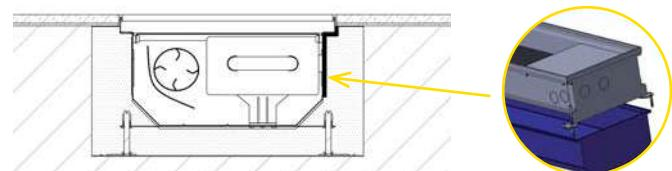
**Рис. 9:** Полный пол – Антивибрационная пленка для внутрипольного конвектора с вентилятором. Она предназначена для снижения шума шагов и гашения вибраций вентилятора и применяется по всему внешнему периметру конвектора.
