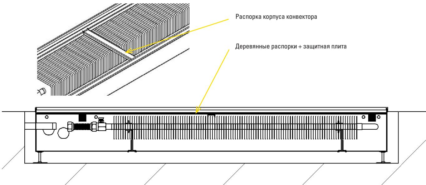
**Рис. 20:** Чтобы избежать загрязнения ниши во время бетонирования, **убедитесь в том, что** все отверстия внутри ниши заделаны! Установить в нишу конвектора распорки короба и деревянные распорки вместе с древесноволокнистой защитной плитой конвектора.
