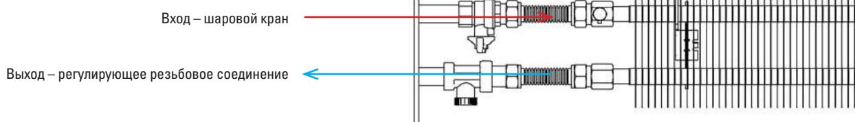
**Рис. 24:** Прямое подключение воды – стандартное исполнение (стандартные принадлежности).
