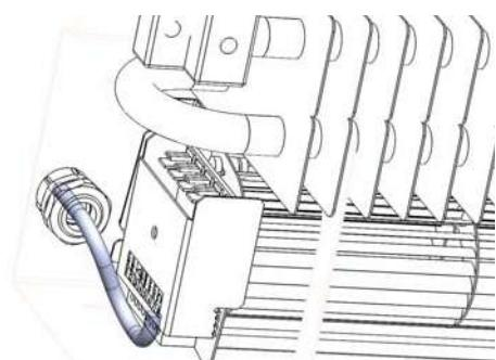
**Рис. 10:** Протянуть кабель через кабельный ввод и подключить блок управления двигателей в соответствии с руководством «Регулирование» в зависимости от выбранного вида регулирования. Проверить соединение.
