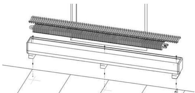
Рис. 6: Установить дюбеля в просверленные отверстия. Снять решетку и теплообменник конвектора. Установить корпус на трубы и дюбеля. Привинтить шурупами к полу корпус конвектора.
