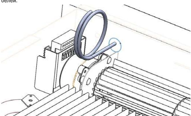
**Рис. 11:** Протянуть кабель через кабельный ввод и подключить блок управления двигателей в соответствии с руководством «Регулирование» в зависимости от выбранного вида регулирования. Проверить соединение.
