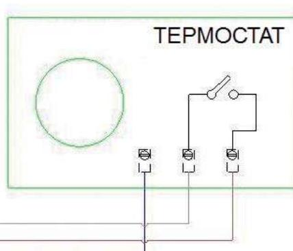
Вариант 1: ветвь с подключенным термоконтактом
