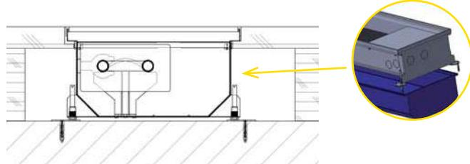
**Рис. 7:** Пустотелый пол – антивибрационная пленка для внутрипольного конвектора без вентилятора. Она предназначена для снижения шума шагов, а также других возможных вибраций, и применяется по всему внешнему периметру конвектора.
