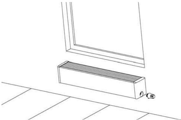
**Рис. 13:** К термостатическому клапану привинтить головку.
