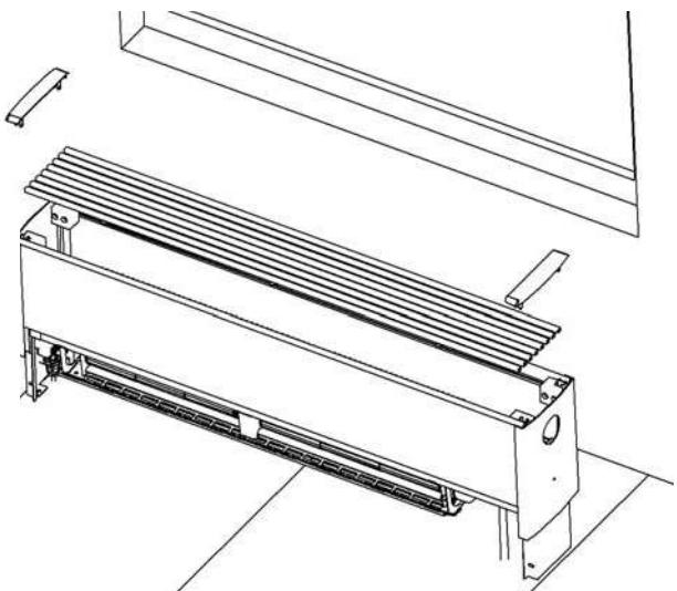
**Рис. 13:** Установить раму конвектора, решетку и крышки.
