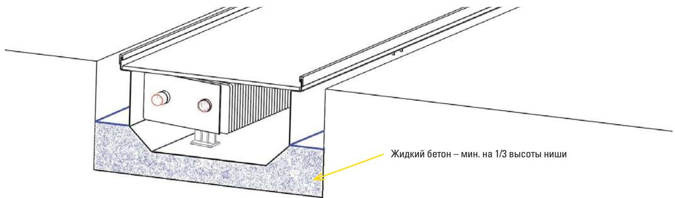
**Рис. 23:** Как минимум, 1/3 высоты конвектора осторожно залить жидким гравийным бетоном или ангидридной смесью для подавления шума до минимума. При плохом бетонировании дна конвектор с вентилятором могут резонировать!
