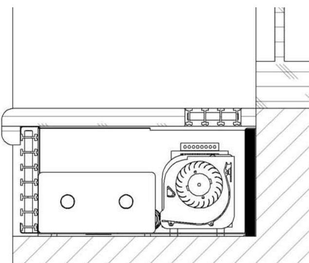
Рис. 4: Теплоизоляция для подоконного конвектора с вентилятором.
