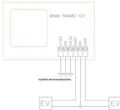
Ручное управление подачей горячей воды в конвекторы при помощи электрического клапана (4-трубные системы)
