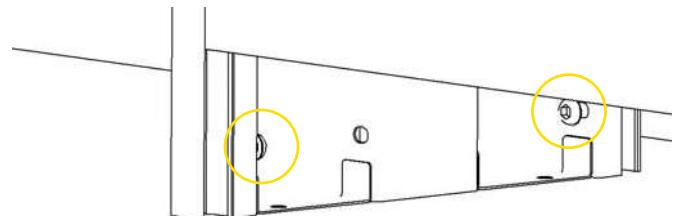
Рис. 3: Ослабьте винты на обеих стойках корпуса конвектора, и снимите верхнюю крышку (винты полностью не ослаблять!).
