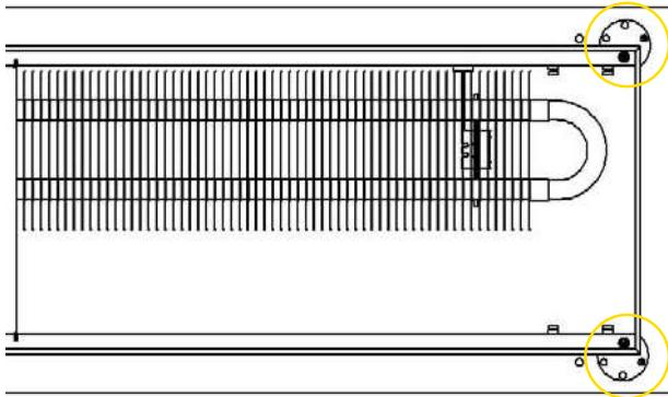
Рис. 16: Прикрепить конвектор при помощи фиксирующих пяты к подготовленным дюбелям. Пяты зафиксировать быстротвердеющим бетоном.
