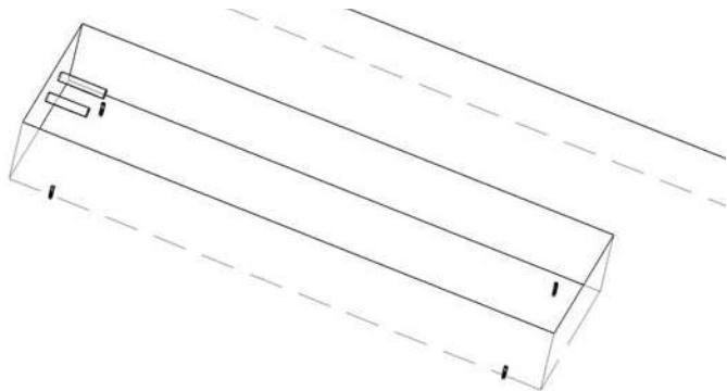
Рис. 13: Просверлить размеченные отверстия Ø 6мм, глубина 30-35 мм. Установить дюбеля в просверленные отверстия.
