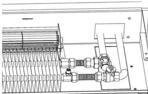
**Рис. 12:** Установить теплообменник и подсоединить арматуру – см. п. 6.
