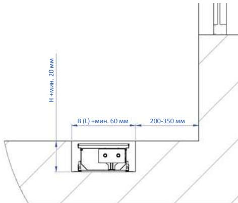
**Рис. 4:** В - максимальная ширина корпуса конвектора; L - длина корпуса конвектора; Н – высота корпуса конвектора (без установочных ножек)
