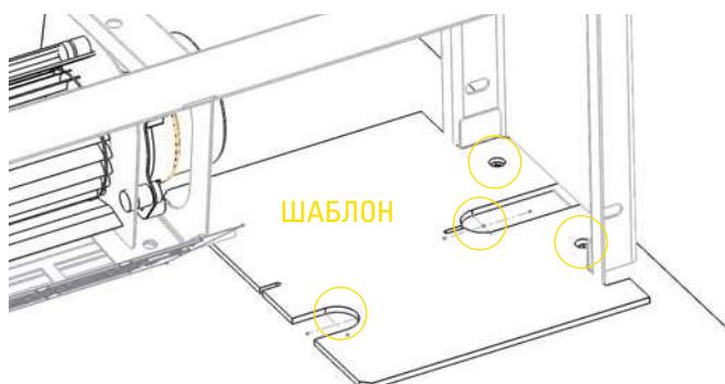
**Рис. 5:** На полу обозначьте вход/выход горячей воды и отверстия для крепления конвектора. Вход направлен к нижнему выходу теплообменника, на который ставится терmostатический клапан. На выход – верхняя трубка – устанавливается регулирующее резьбовое соединение.
