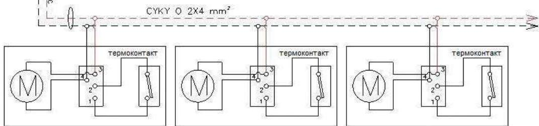
Сечения проводов выбираются в зависимости от токовой нагрузки и длины подводящих проводов. В случае использования здесь указанных сечений проводов максимальное допустимое расстояние между конвектором и трансформатором составляет 15 м.
