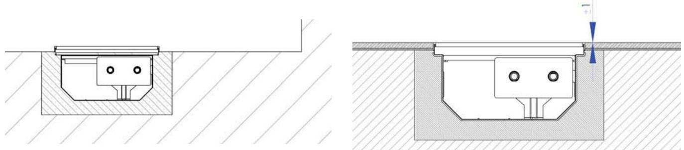
**Рис. 24:** Очень важно, чтобы вся внешняя поверхность конвектора была позже залита классическим бетоном, вплоть до окончательной высоты черного пола. Конвектор сейчас забетонирован до черного пола, который готов к укладке финального покрытия (паркет, плитка и т.д.).
