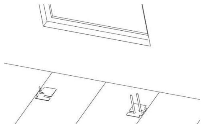
**Рис. 8:** Просверлить отверстия для крепления конвектора к полу.
