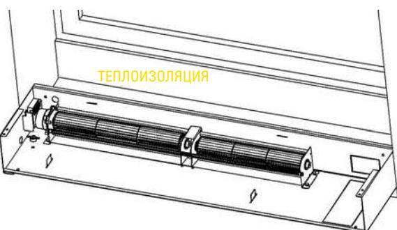
**Рис. 6:** Между конвектором и задней стороной положить теплоизоляцию.
