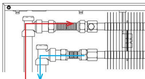
Рис. 27: Боковое подключение воды – подключение от окна – (нестандартные принадлежности – угловое соединение)
