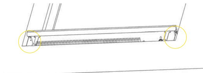
**Рис. 15:** Потянуть доску подоконника с нижней стороны корпуса конвектора. Стыки между стеной и подоконником заделать подходящим герметиком.
