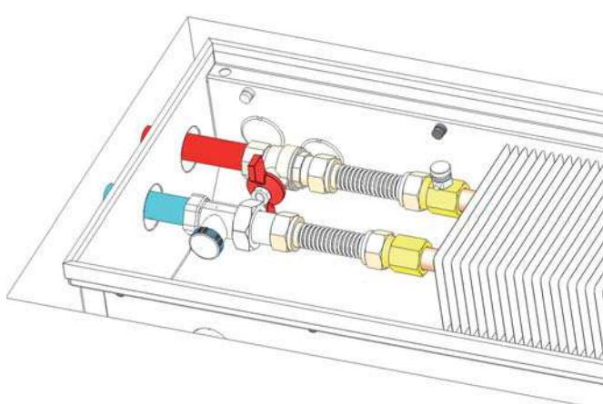
**Рис. 18:** Подключить подводящие и отводящие трубы. См. п. 6
