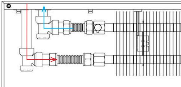
**Рис. 26:** Боковое подключение воды – подключение «от окна» – (нестандартные принадлежности – угловое соединение).
