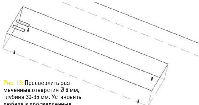
Рис. 13: Просверлить размеченные отверстия Ø 6 мм, глубина 30-35 мм. Установить дюбеля в просверленные отверстия.
