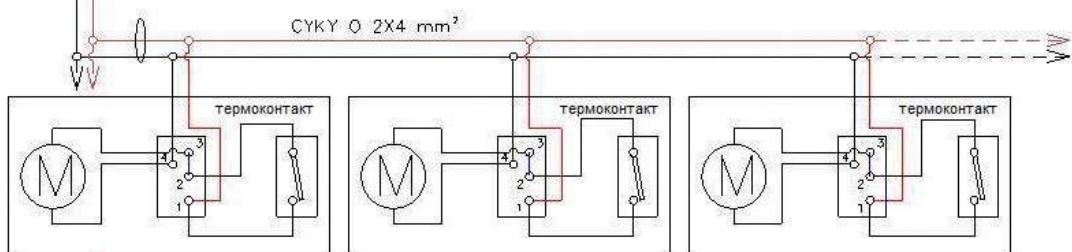
Вариант 2: ветвь без подключенного термоконтакта
