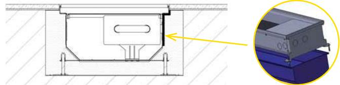
**Рис. 9:** Полный пол – антивибрационная пленка для внутрипольного конвектора без вентилятора. Она предназначена для снижения шума шагов, а также других возможных вибраций, и применяется в основном по всему внешнему периметру конвектора.
