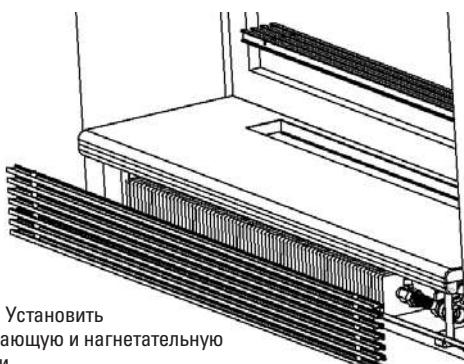
**Рис. 16:** Установить всасывающую и нагнетательную решетки.
