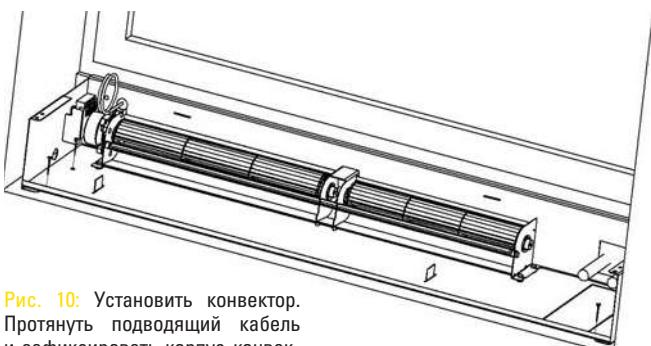
**Рис. 10:** Установить конвектор. Протянуть подводящий кабель и зафиксировать корпус конвектора при помощи шурупов и дюбелей.
