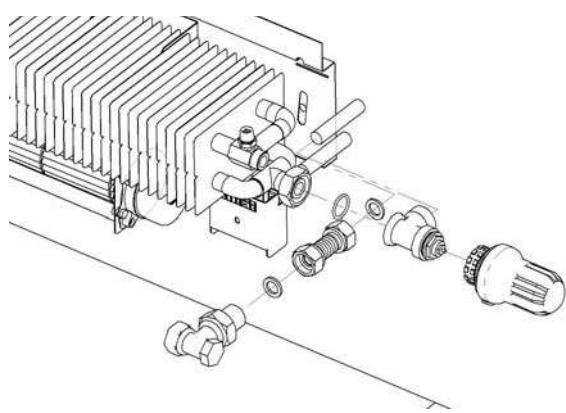
**Рис. 11:** Подсоединить арматуру. Вход – термостатический клапан. Выход – регулирующее резьбовое соединение. Проверить герметичность соединений.
