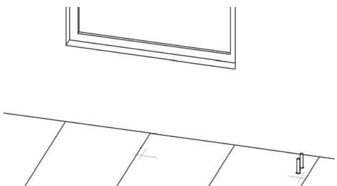
Рис. 5: Просверлить отверстия для крепления корпуса конвектора и подвести в полу подводящие и отводящие трубы теплоносителя.
