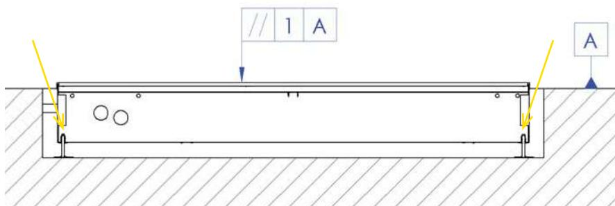
**Рис. 18:** При помощи установочных винтов конвектор с планками выровнять в один уровень. Отрегулировать высоту так, чтобы планки конвектора соответствовали готовому полу  $\pm 1$  мм. Пяты зафиксировать быстротвердеющим бетоном.
