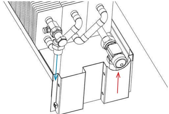
**Рис. 9:** Установить теплообменник и подсоединить арматуру – см. п. 6. Проверить герметичность подсоединения арматуры.
