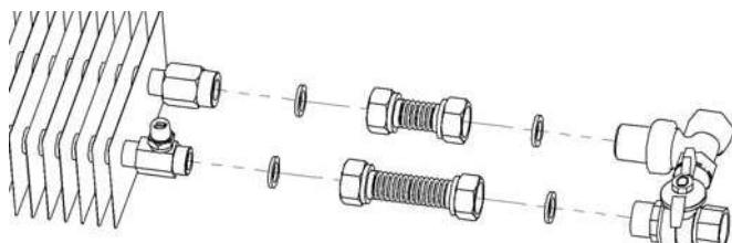
**Рис. 17:** Подсоединение арматуры для отопительного прибора КР.
