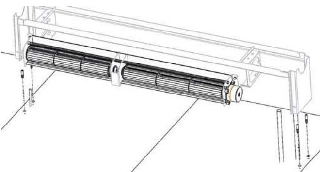
**Рис. 9:** Установить дюбеля и установить несущую раму конвектора.
