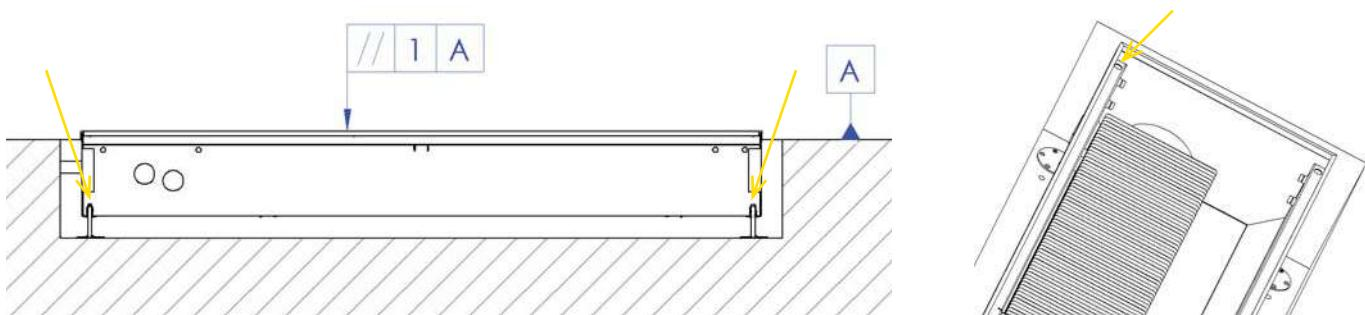
**Рис. 17:** При помощи установочных винтов конвектор с планками выровнять в один уровень. Отрегулировать высоту так, чтобы планки конвектора соответствовали готовому полу  $\pm 1$  мм.
