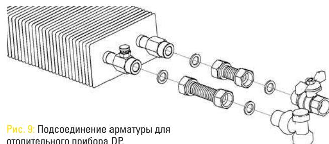
**Рис. 9:** Подсоединение арматуры для отопительного прибора DP.
