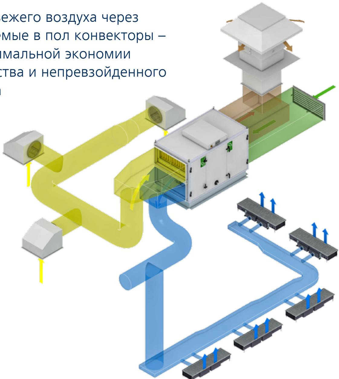
Практически все **встраиваемые в пол конвекторы Katherm** для особых проектов могут быть оснащены **функцией подачи приточного воздуха**. С помощью различных вариантов патрубков приточного воздуха предварительно обработанный центральной вентиляционной установкой свежий воздух подается в помещение. Таким образом идеально комбинируется обогрев, охлаждение и приточная вентиляция. За счет этого потребность в пространстве сводится к минимуму, а комфорт в здании повышается до максимума.
