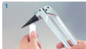
1 Смажьте конус инструмента графитовой смазкой Uponor
