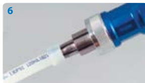
6 Введите сегменты головки максимально глубоко в трубу и расширьте
