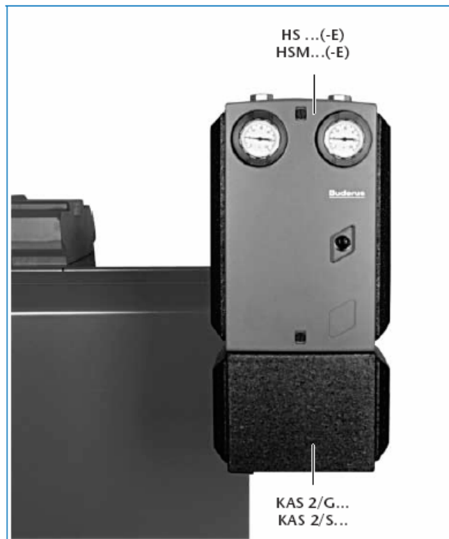
4/1 Комплект подключения котла KAS 2/... для бокового монтажа одного, двух или трех комплектов подключения отопительного контура HS ...(-E) или HSM ...(-E) на напольном котле Logano G... или S... (вариант установки → 26/1, 36/1 или 45/1)
