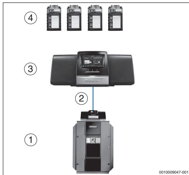
Рис. 29 Система управления Logamatic 5311 для напольных котлов с горелками сторонних производителей
