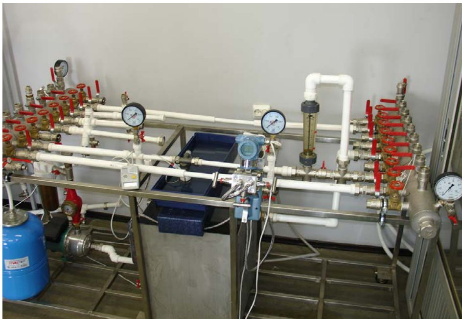
Рис.2.4.3.р.8 Стенд гидравлических испытаний
