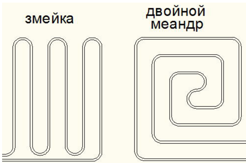
Рис.5.3.1.4. р.1 Способы раскладки петель теплого пола
