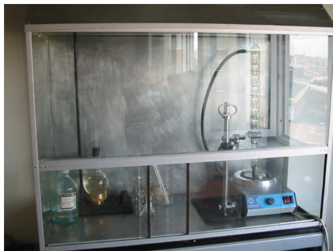
Рис.2.2.р.1 Стенд определения степени сшивки
