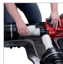
Наденьте на трубу кольцо до упора и расширьте трубу вместе с кольцом. Для равномерного расширения, головка инструмента автоматически поворачивается.
