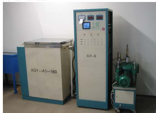
Рис.2.4.3.р.3 Стенд статических испытаний МПТ
