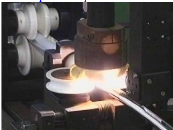
Рис.2.4.2.р.1 TIG сварка алюминия
